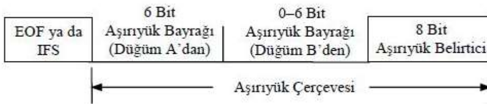
Şekil 4.5. CAN aşırı yük çerçevesi [2].
