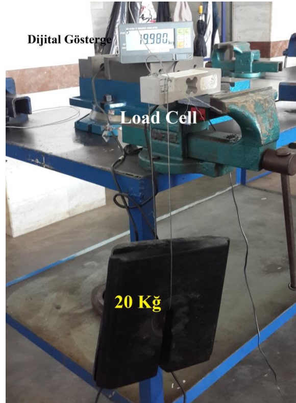
Şekil 4.15. Load cell kalibrasyon işlemi
