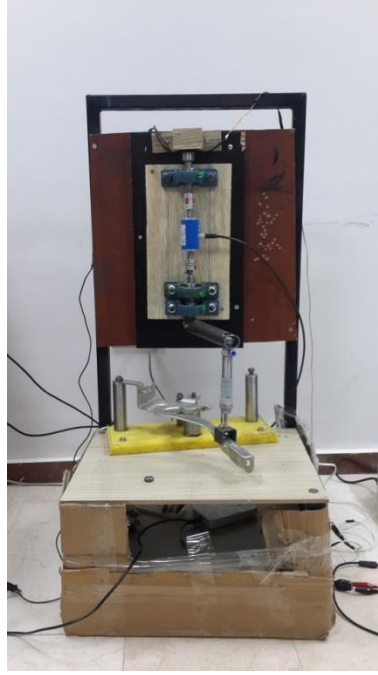
Şekil 3.31. Tork ölçüm sistemi
