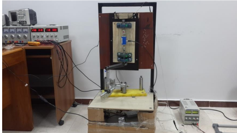
Şekil 3.33. Tork düzeneğinin karkasa dikey konumda montajı
