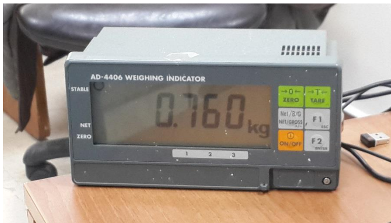
Şekil 4.20. Load cell den okunan yük
