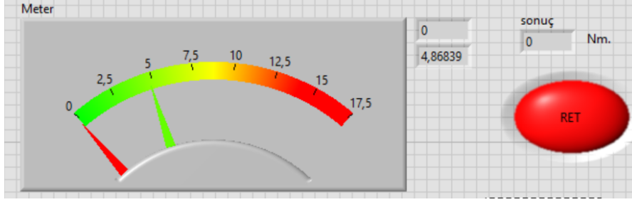
Şekil 3.17. Elektriksel sinyalin Nm'ye dönüşümü (Front Panel)
