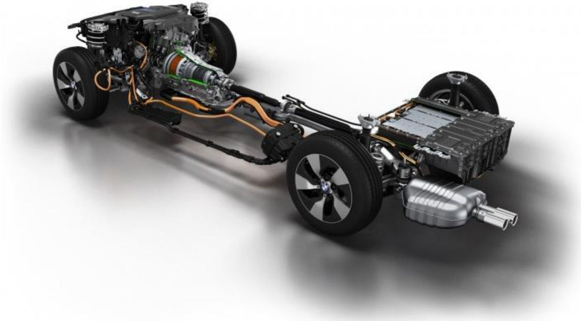
Şekil 2.1. Elektrikli taşıt sistemi [6]
