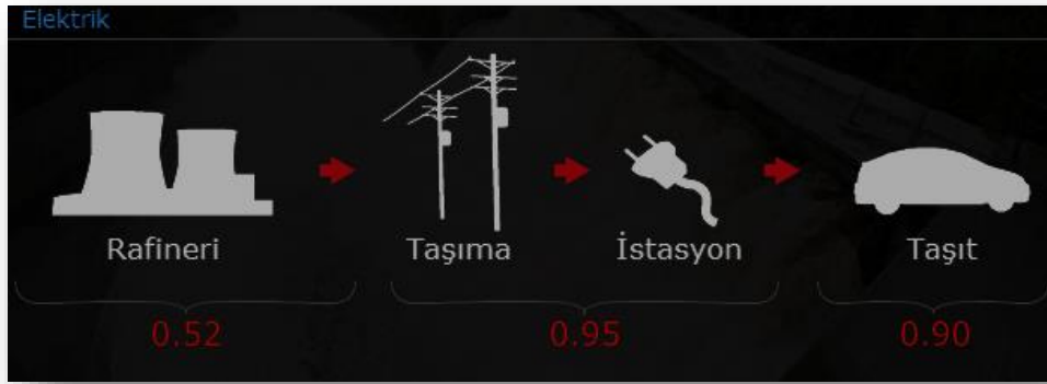
Şekil 2.13. Elektrik'in Kaynaktan Tekere Verimi [27]
