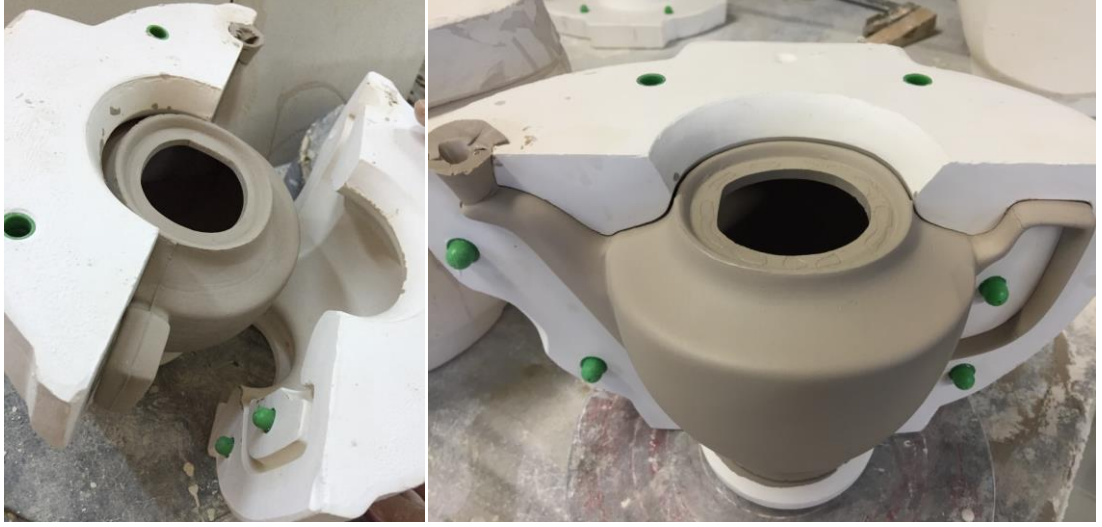
Görsel 79: Kalıbın Açılması ve Mamulün Bekletilmesi
