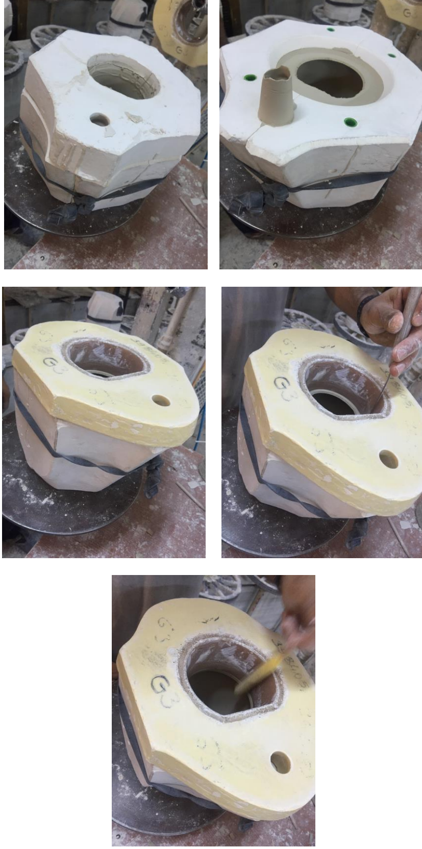
Görsel 37: Döküm Aşamasında Deformasyon Önlemek İçin Kullanılan Kesme Şablonu
