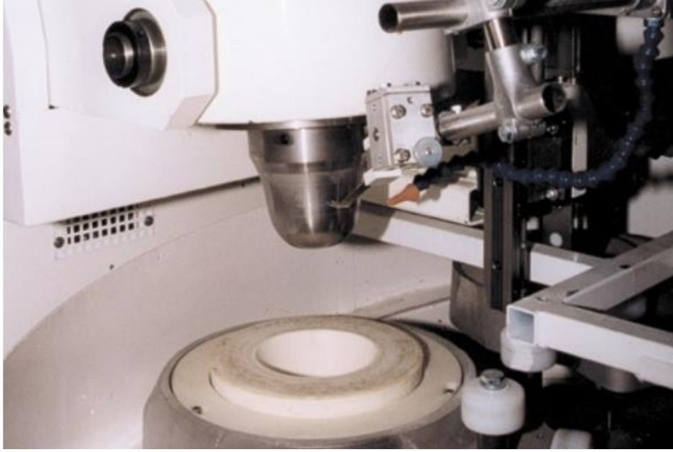
Görsel 6: Plastik Şekillendirme Sisteminde Metal Şablon
