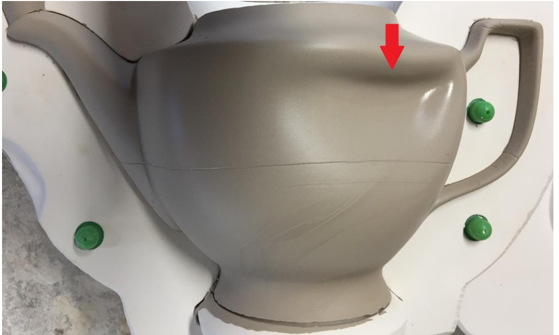
Görsel 38: Mamulün Vakum Yapması Sonucunda Çökmesi
