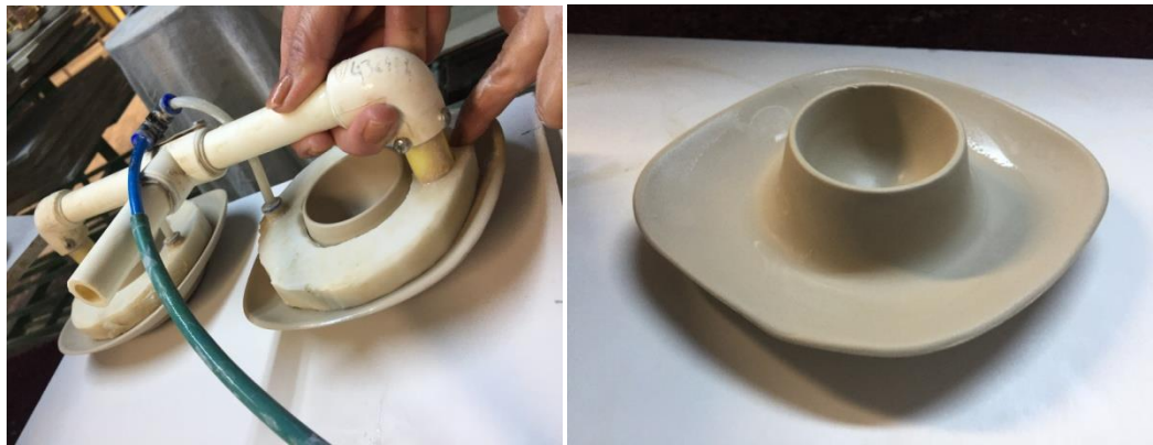
Görsel 40: Vantuz Yardımıyla Mamulün Bırakılması
