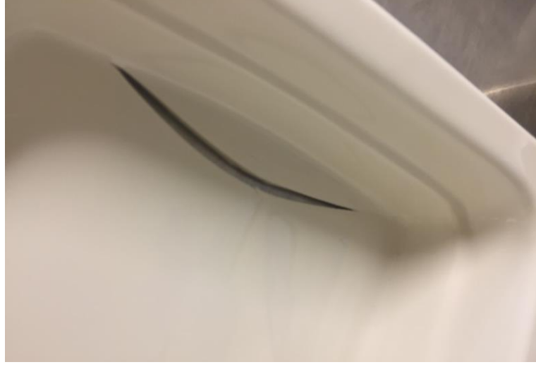
Görsel 34: Basınçlı Döküm Sisteminde Ürün Çatlağı
