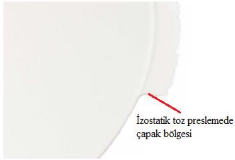
Görsel 5: İzostatik Toz Presleme Rötuşlama Aşamaları
