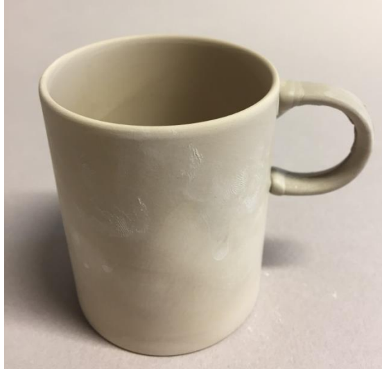
Görsel 42: Plastik şekillendirme sisteminde kulp eğilmesi
