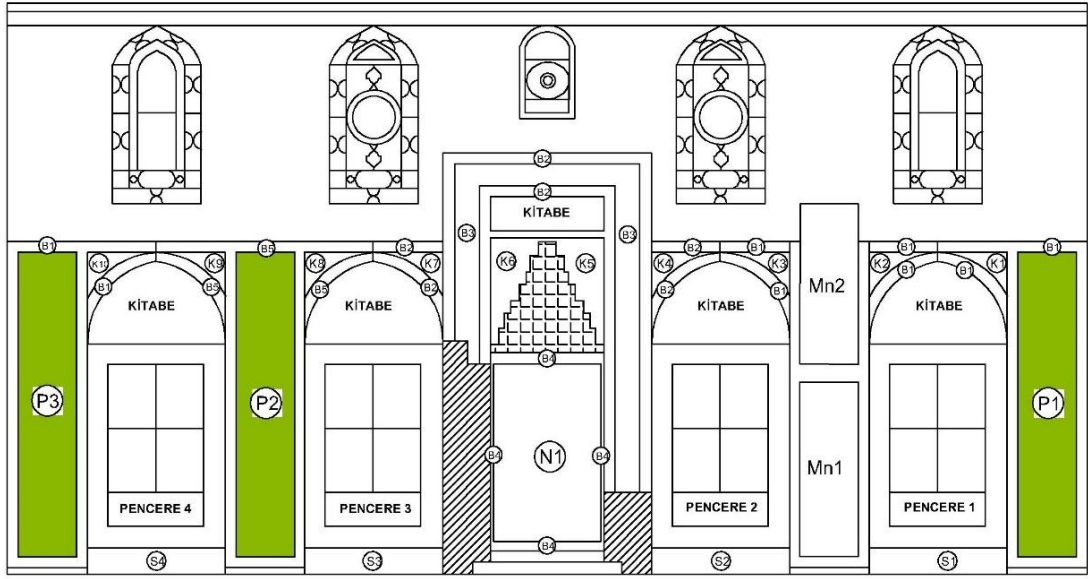
Mihrap Duvarında Panoların Yer Aldığı Alanlar
