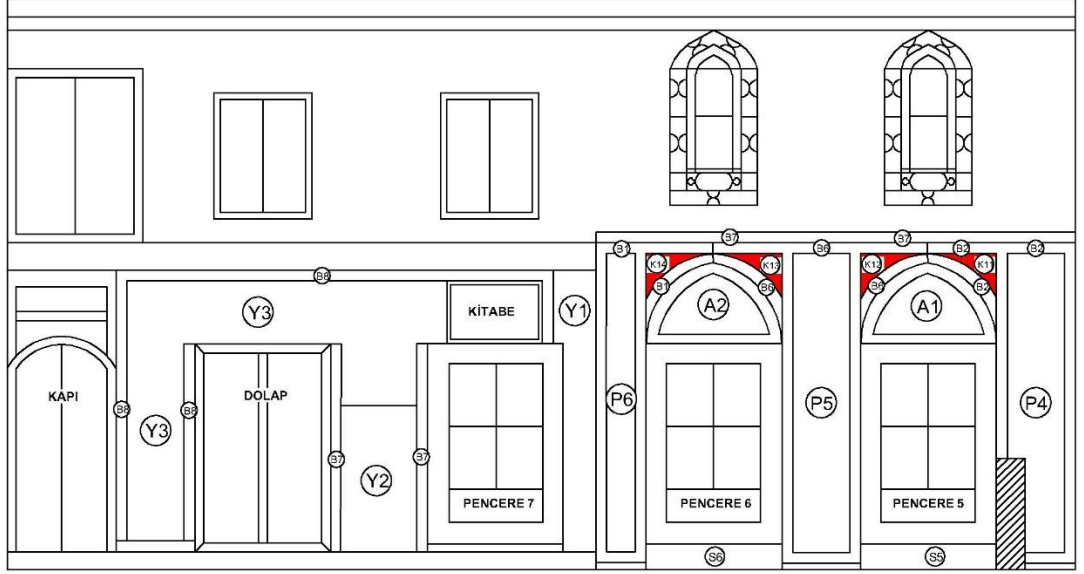
Doğu Duvarda Köşebentlerin Yer Aldığı Alanlar
