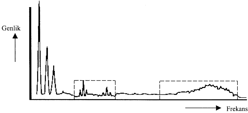
Şekil 6.29 İlerlemiş rulman hasar frekansı
