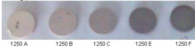
Şekil 6.3. 1250 °C sinterlenen numunelerin sinterleme sıcaklığı ve silika dumanı ilavesine göre renk değişimi
