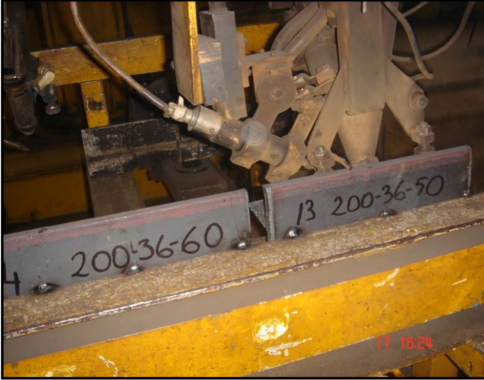
Şekil 4.4. Deneyin Yapıldığı Tozaltı Kaynak Makinesi (Kaynak Esnasında)
