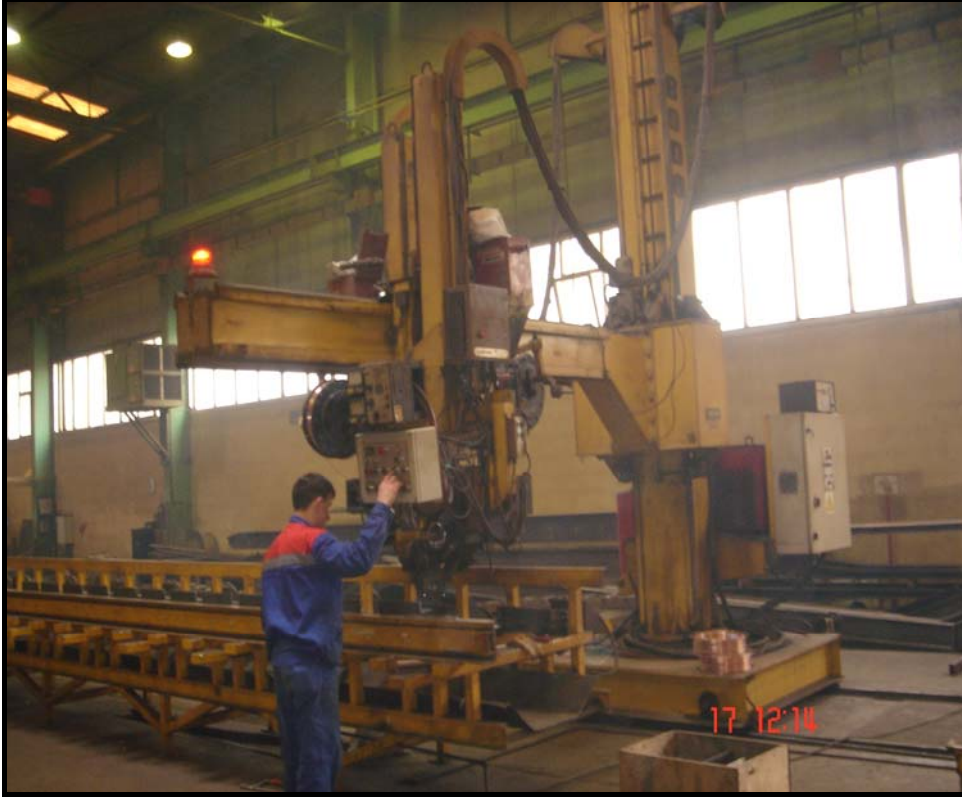
Şekil 4.2. Deneyin Yapıldığı Tozaltı Kaynak Makinesi
