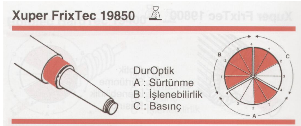
Şekil 4.1 Xuper Frixtec 19850 tozuna ait duroptik daire[39]
