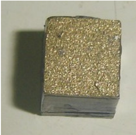
Şekil 5.27 %100 kohezyon bağlardan kopma
