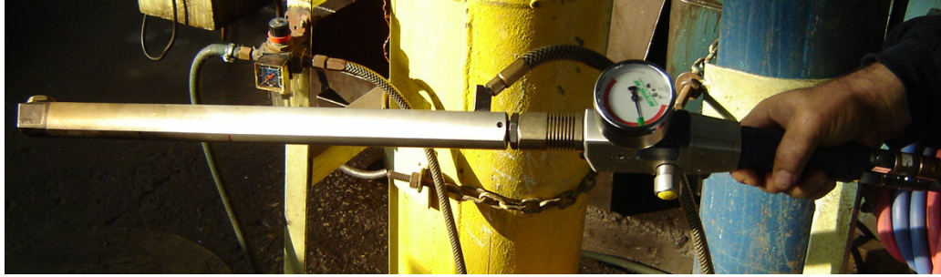
Şekil 4.4 Toz püskürtme tabancası iç çap kaplama ( uzatma ) nozulu
