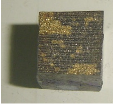
Şekil 5.26 %80 adhezyon bağlardan, %20 kohezyon bağlardan kopma
