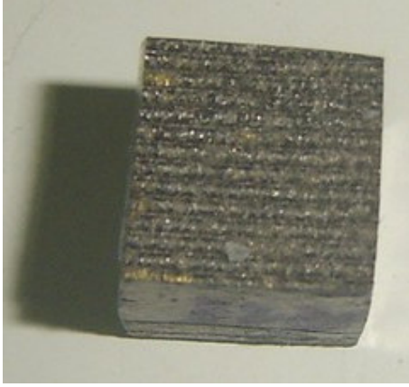
Şekil 5.25 %100 adhezyon bağlardan kopma
