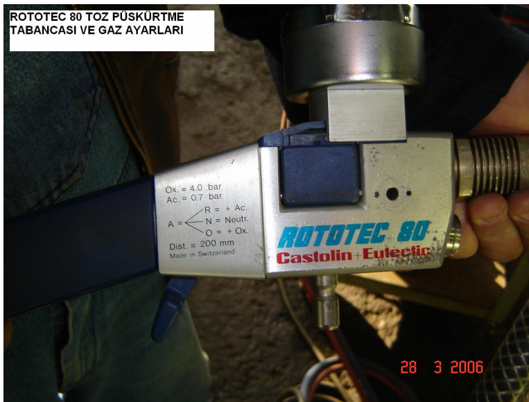
Şekil 4.5 Toz püskürtme tabancası ve gaz ayarları
