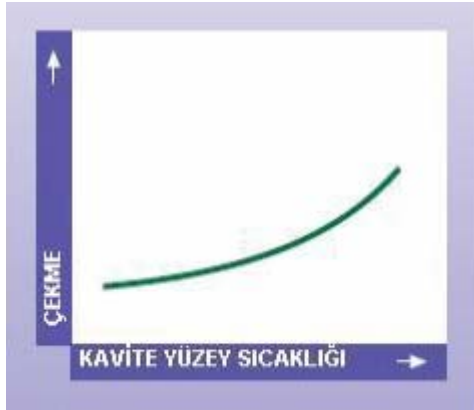
Şekil 3.6. Kavite yüzey sıcaklığının, çekme davranışı üzerine etkisi [9]
