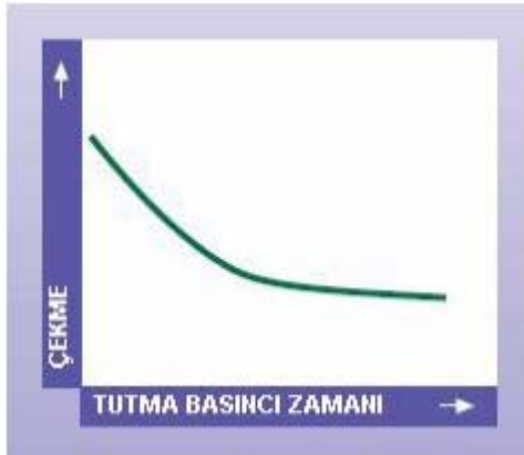
Şekil 3.4. Tutma basıncı uygulama zamanının çekme davranışı üzerindeki etkisi [9]
