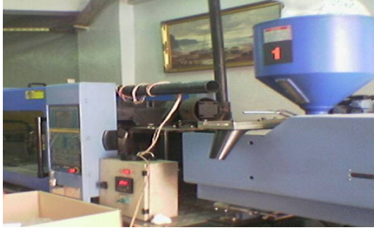
řekil 5.10. Sekizgen kutu kapađının retildiđi plastik enjeksiyon makinası
