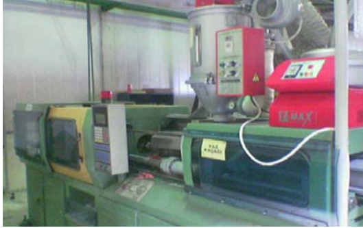
řekil 5.11. Diyafram tablasının retildiđi plastik enjeksiyon makinası
