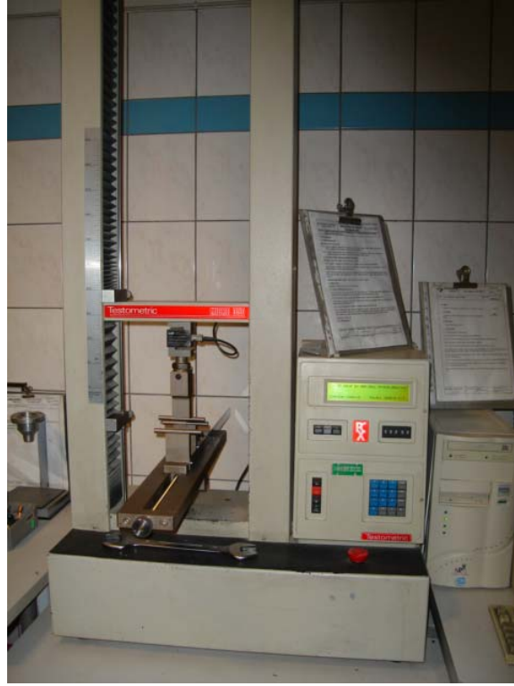
Şekil 4.4. Çekme ve eğme deneylerinin yapıldığı Testometric 350 adlı cihaz
