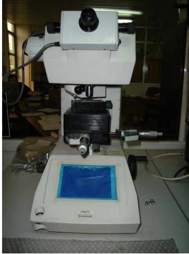
Şekil 4.1. Sertlik ölçümlerinin yapıldığı Shimadzu marka mikrosertlik cihazı
