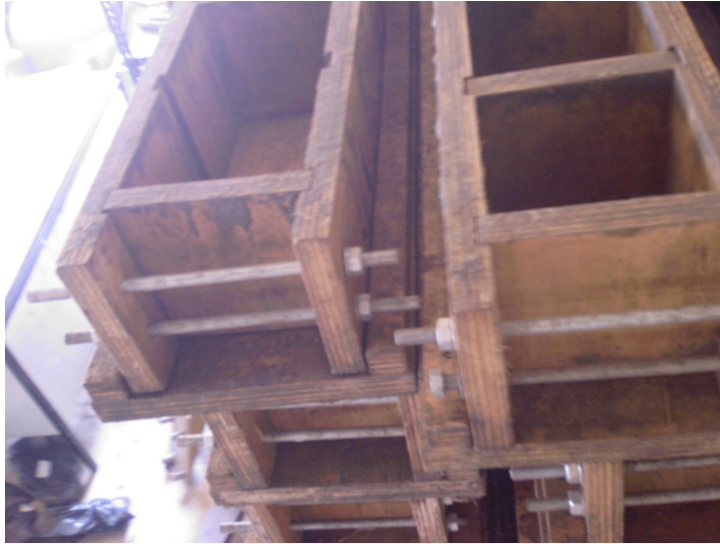
Şekil 6.1. Deney beton numune kapları perspektif görünümü
