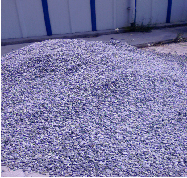
Şekil 6.5. Beton karışımı için gerekli olan agregadan bir görünüm
