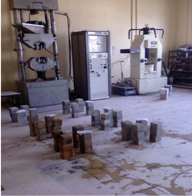
Şekil 6.19. Beton basınç deney numuneleri
