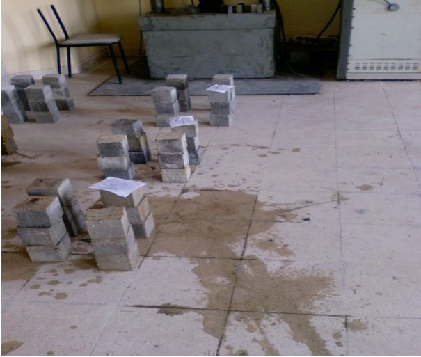
Şekil 6.15. Kırım için hazırlanan deney numuneleri
