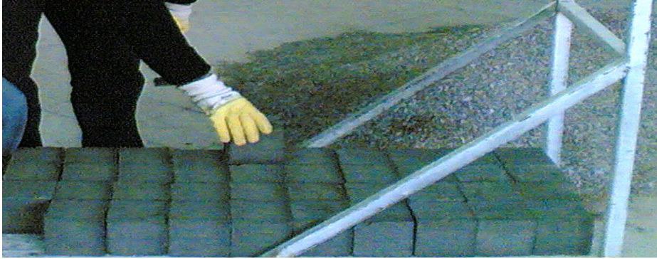
Şekil 6.13. Kalıplardan çıkarılmış beton numuneleri
