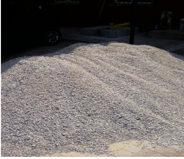
Şekil 6.4. Beton karışımı için gerekli olan agregadan bir görünüm
