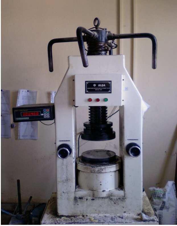
Şekil 6.20. Beton basınç ölçüm cihazı
