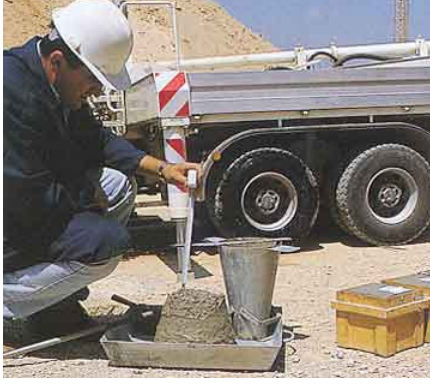
Şekil 3.2. Slamp deneyi görüntüsü
