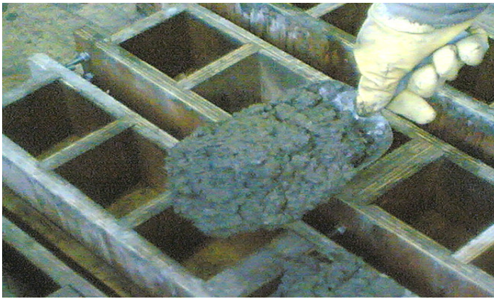
Şekil 6.9. Kalıplara 2 kademede numune yerleşimi
