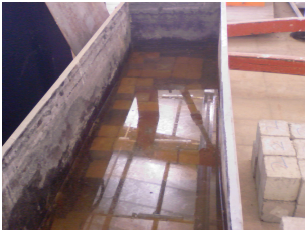
Şekil 6.18. Magnezyum sülfatı numuneler için kür havuzu
