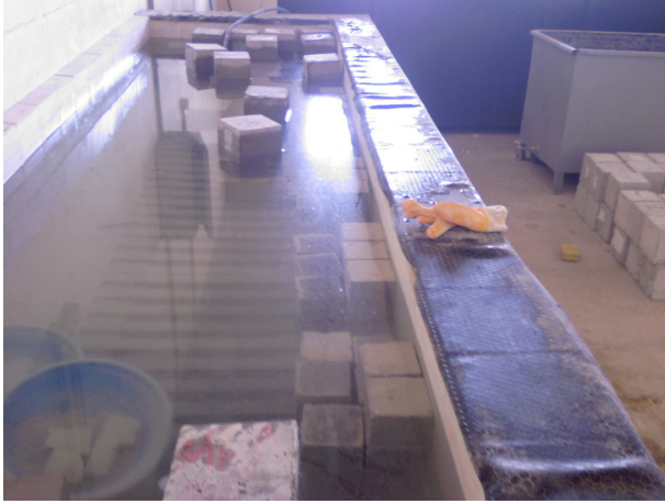
Şekil 6.17. Şahit numuneler için kür havuzu
