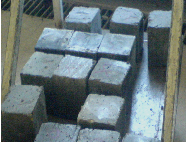
Şekil 6.12. Kalıplardan çıkarılmış küre hazır numuneler
