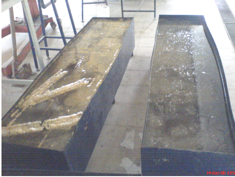
Şekil 5.6. Hidroklorik asit (HCl) ve nitrik asit (HNO 3 ) bulunan kür havuzları
