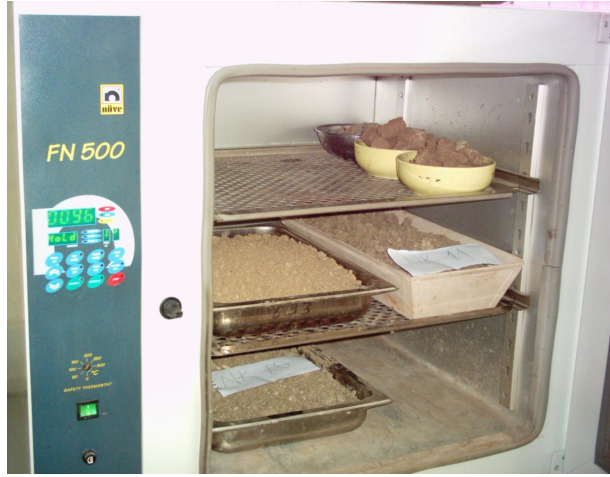
Şekil 3.5. Deneş örneđinin pota il birlikte etüve konması
