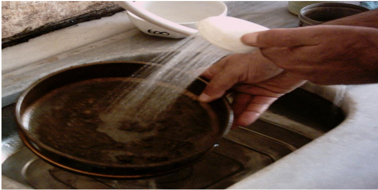
Şekil 3.2. Deney örneğinin yıkanması
