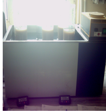
Şekil 3.7. Çöktürme silindirinin su banyosuna yerleştirilmesi
