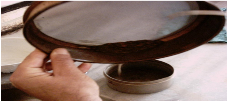
Şekil 3.3. Deney örneğinin yıkama sonunda porselen potaya aktarılması
