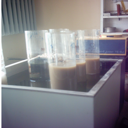
Şekil 3.7. Çöktürme silindirinin su banyosuna yerleştirilmesi
