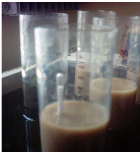
Şekil 3.8. Hidrometre okumasının alınması
