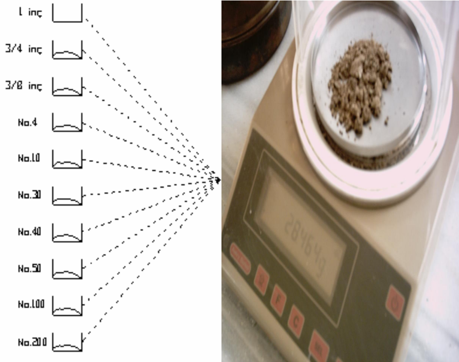
Şekil 3.4. Eleğin üzerinde kalan danelerin tartılması
