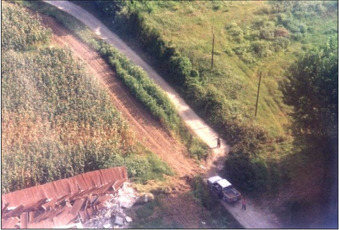
Resim 4.1. Arazide görülen yüzey kırıkları ve yüzey kırığı üzerinde gözlenen yaklaşık 3 m lik sağ yanal yer deęiřtirme [42]
