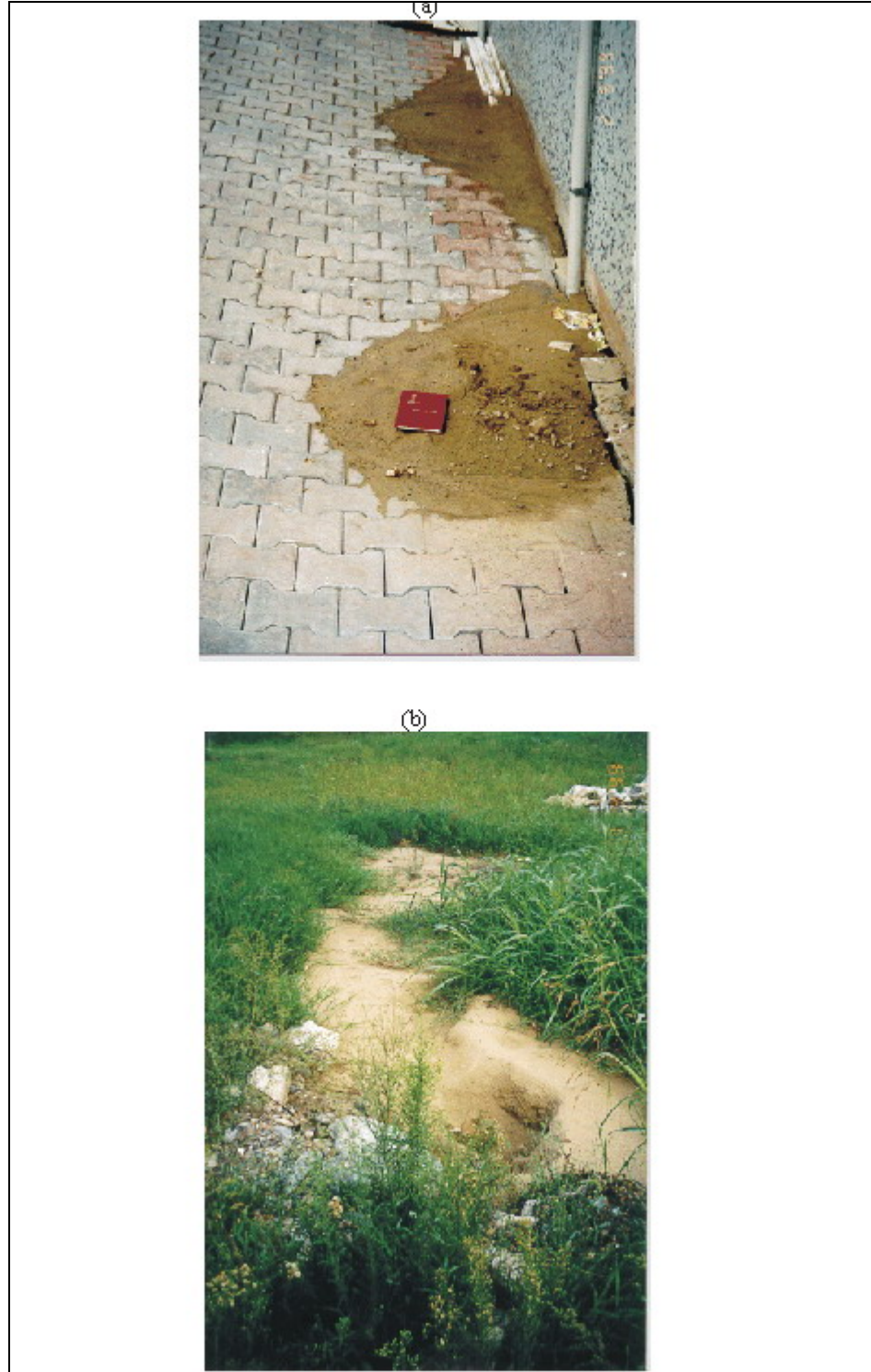
Resim 5.2. Adapazarında sıvılaşmaya bağlı tipik kum kaynamaları. (a) Adapazarı – Tığcılar mahallesinde yeni bir yapı (b) Adapazarı – Başak Traktör Fabrikası' nın bahçesi [25]
