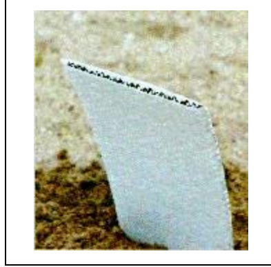
Resim7.5. Zemine uygulanmış prefabrike dren [77]
