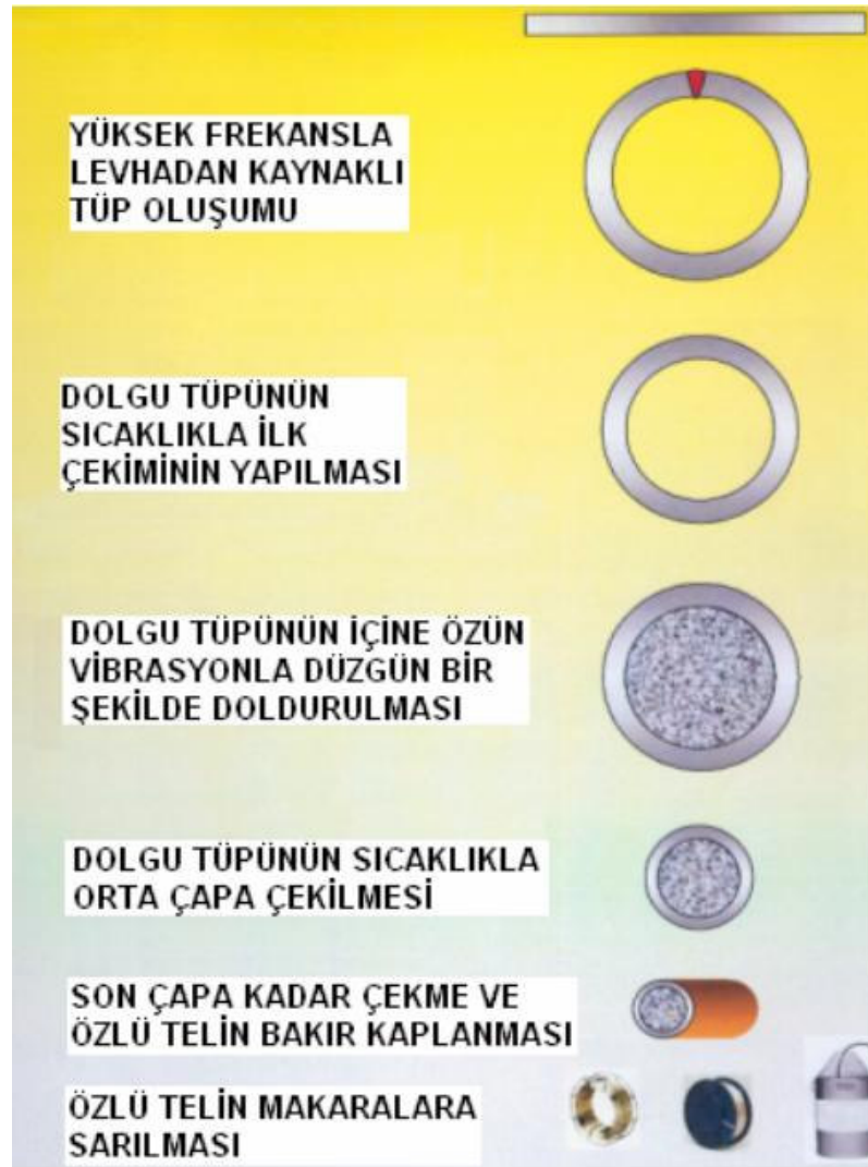
Şekil 4.3. Özlü tel üretim şeması [14]
