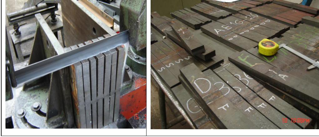
Şekil.7.8. Test parçalarının şerit testere ile kesilmesi
