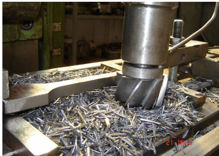
Şekil.7.12. Freze tezgahında çekme parçalarının hazırlanması
