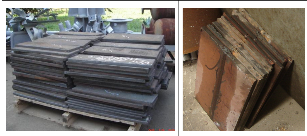
Şekil.7.1. Test parçalarının kesilmesi ve kaynatılması
