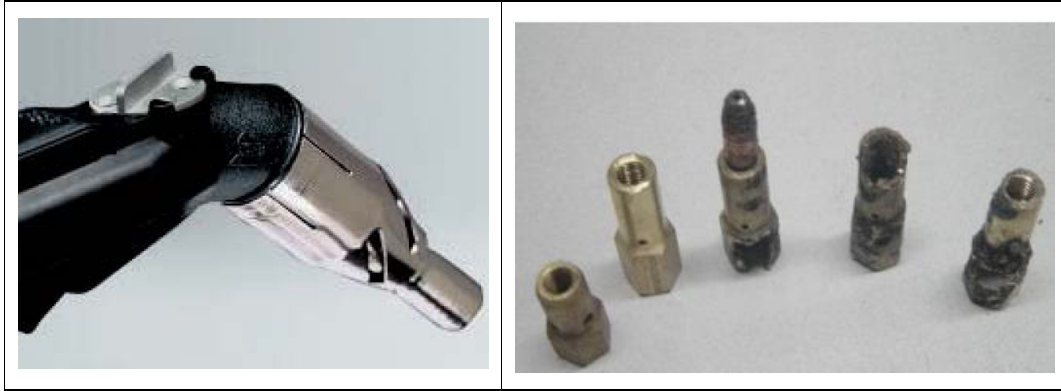
Şekil 4.7. MIG-MAG kaynak yöntemindeki kullanılan torclar ve akım kontaktörleri [18]
