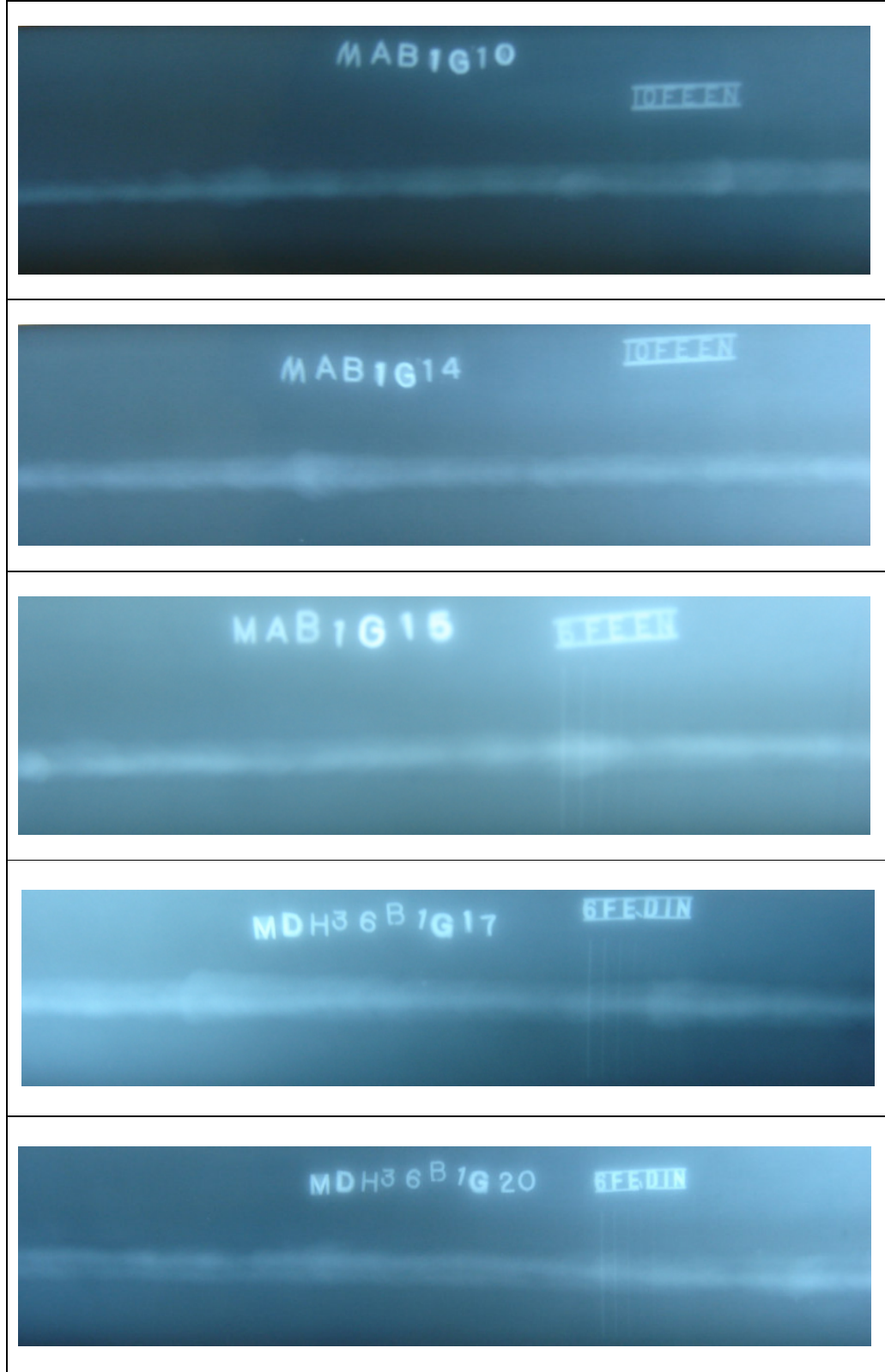
Şekil 7.5. Elektrod ark kaynağı yapılmış kaynaklı numunelerinin radyografik filmleri
