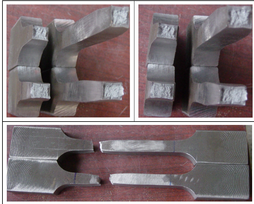
Şekil 8.11. Kaynaklı numunelerin sünek kırılma tipleri
