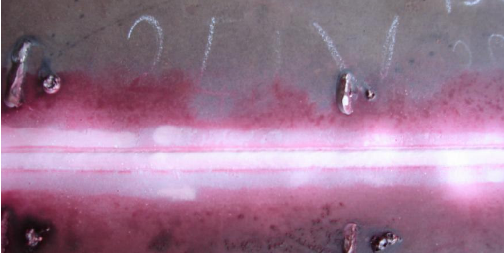
Şekil 7.4. Kaynaklı numunelerin sıvı penetrantla muayenesi
