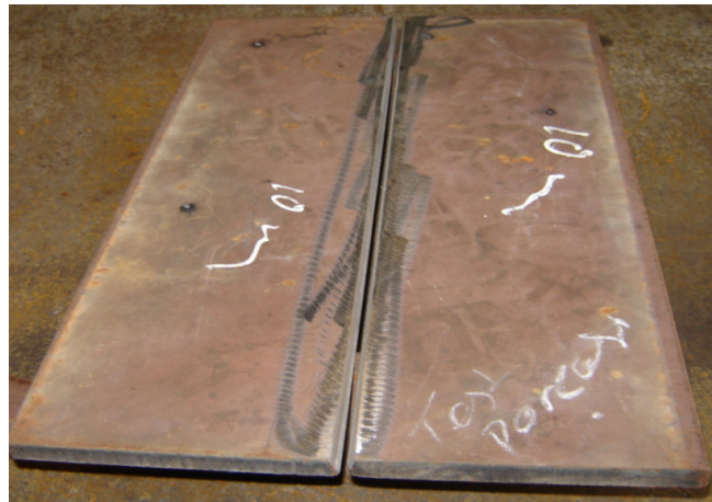
Şekil.7.2. Test parçalarının puntalanması ve uygun kök açıklığı bırakılması
