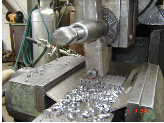
Şekil 7.15. Çentik-darbe numunelerinin kalınlıklarının düşürölmesi
