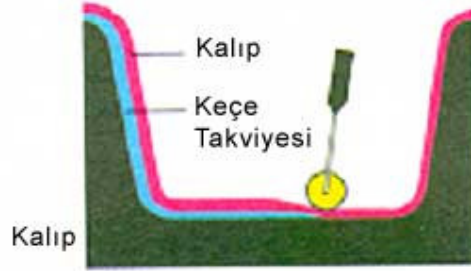
Şekil 4.4. El yatırması metodu ile CTP' nin kalıplanması
