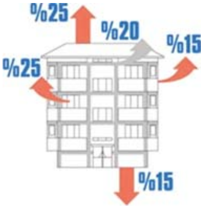
Şekil 7.11 Yapıda ısı kayıpları
