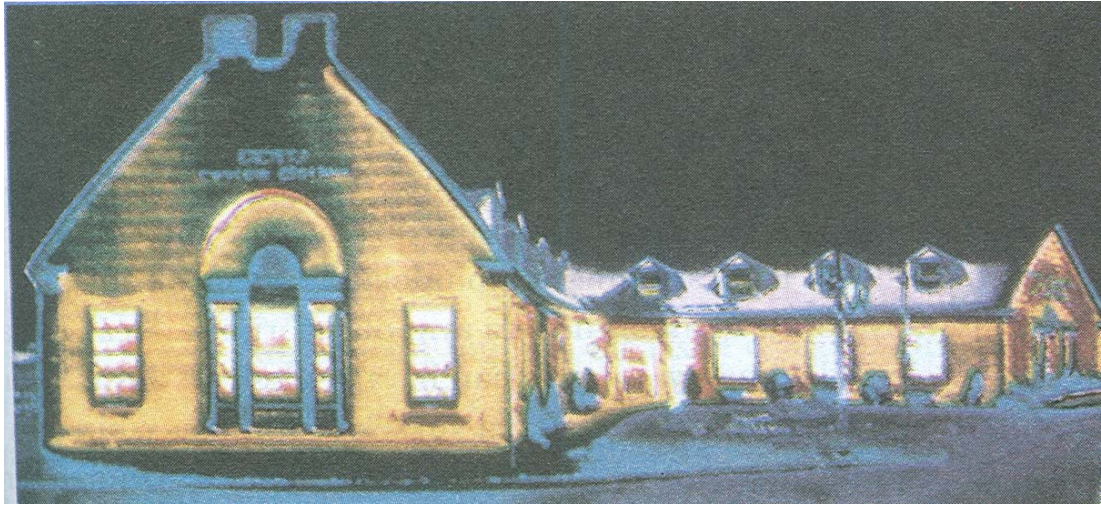
Şekil 1.3 Bu termogramdaki evler gemici fenerlerine çok benzerler. Evlerin içindeki ısı dışarı kaçmaktadır. Soğuk bir günde alınan bu görüntü, kızıl ötesi ışık kullanan bir tarayıcı ile oluşturulmuştur. (VANSCAN*Thermogram Daedalus Enterprises Inc.)
