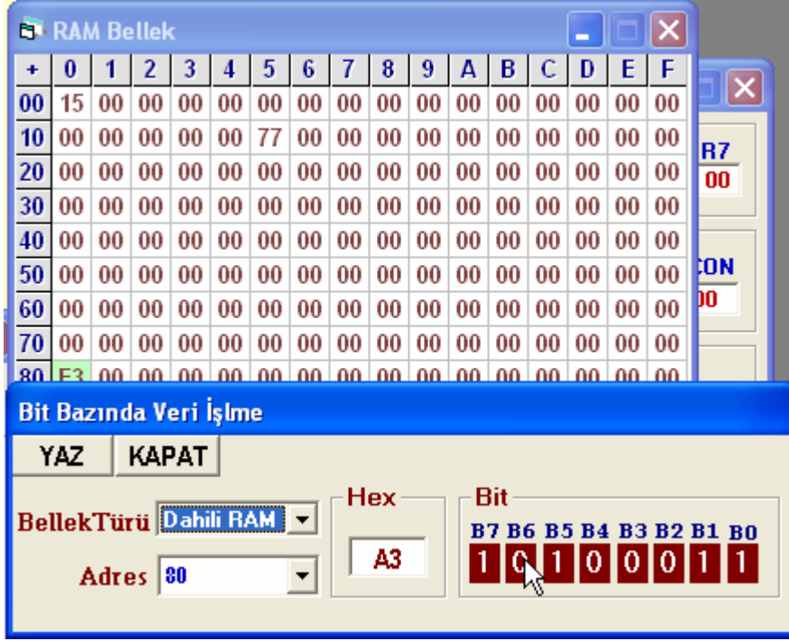
Şekil 4.10. Bellek hücresindeki verilerin bit bazında değerinin değiştirilmesi
