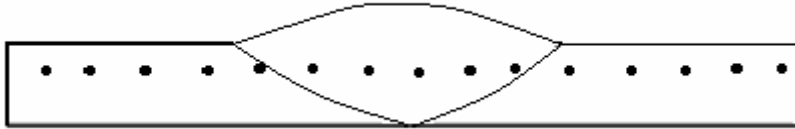
Şekil 4.2. Şematik olarak gösterilen birleştirilmiş paslanmaz çelik numunenin Vickers sertlik değerlerinin alındığı bölgeler.
