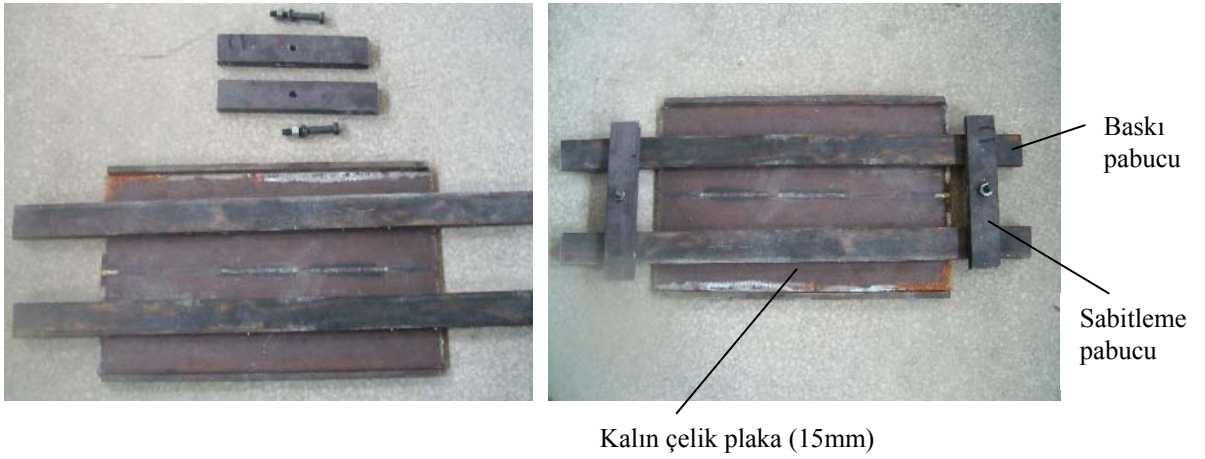
Şekil 5.3. Levhaların bağlandığı kalıp ve pabuçlar
