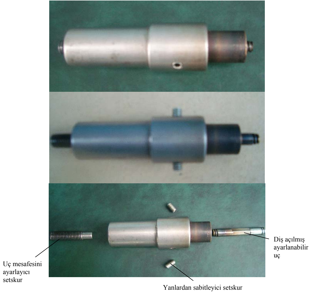
Şekil 5.2. Bu çalışmada kullanılan kaynak ucu
