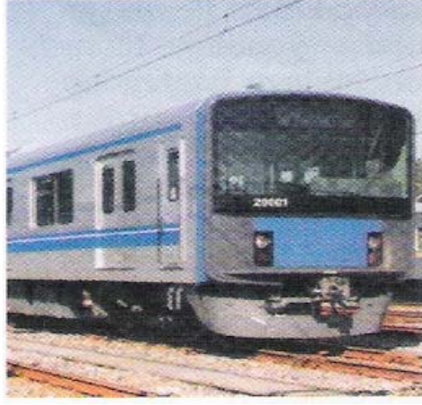
Şekil 2.28. Hitachi tarafından yapılan, tek taraftan tüm uzunluk boyunca sürtünme karıştırma kaynağı yapılmış olan bir tren [12]
