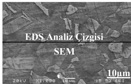
(a) ITAB'ın mikroyapısı
