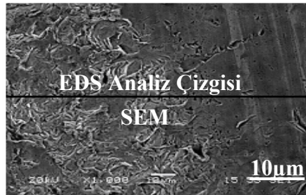
(a) Karışım bölgesinin mikroyapısı
