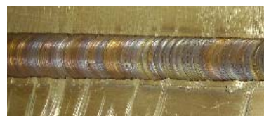
b) İyi yüzey kalitesine sahip kaynak dikişi
