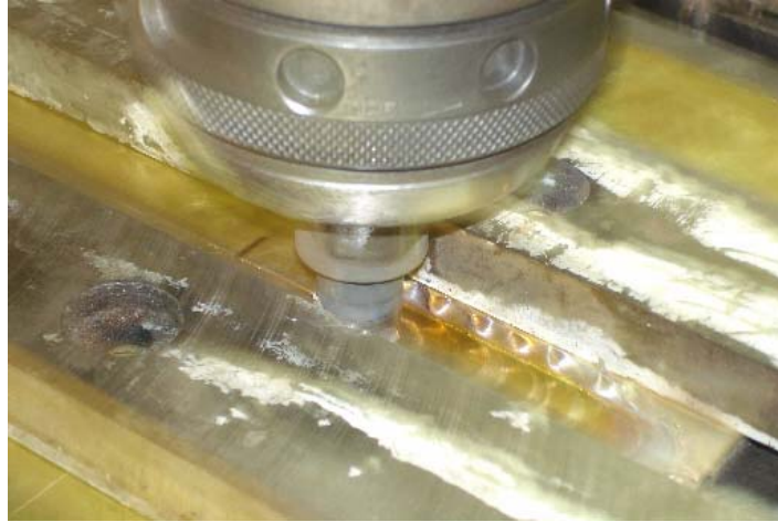
Şekil 6.16. Karıştırıcı ucun yüzey çıkıntısının kaynak işleminin yapılması esnasında malzeme yüzeyinden kaldırdığı çapaklar
