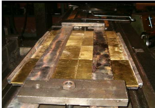
Şekil 6.14. Basit bir kalıpta baskı pabuçları ile sabitlenip kaynak işlemine hazırlanmış parçalar
