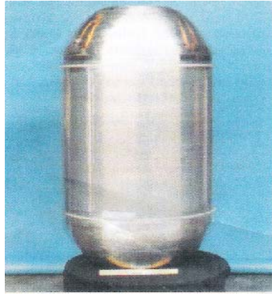
Őekil 2.33. SKK tekniđi kullanılarak boyuna ve evresel kaynakları yapılmıŐ cryogenik bir tankın grnŐ [12].
