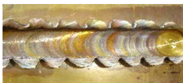
a) Kötü yüzey kalitesine sahip kaynak dikişi
