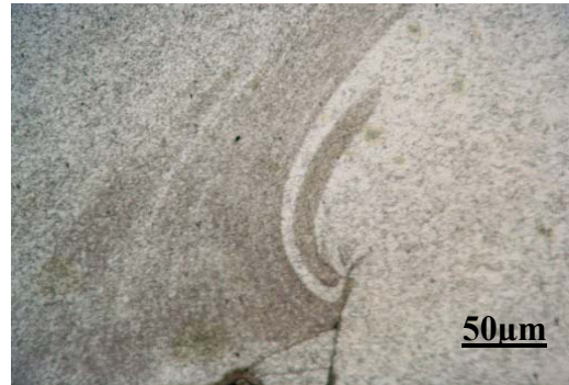
(f) Kaynağın kök kısmı mikroyapısı (şematik resimde gösterilen 6 bölgesi)
