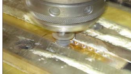
d) Sürtünme etkisiyle oluşan ısı sayesinde hamurumsu hale gelen levhaların birleşmesi.
