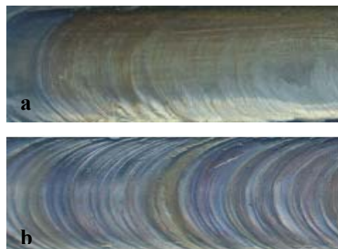
Şekil 2.17. Sürtünme karıştırma kaynağında elde edilen kaynak yüzey kaliteleri. a) İstikrarlı karıştırıcı uç ilerlemesi ve b) İstikrarsız karıştırıcı uç ilerlemesi [33].
