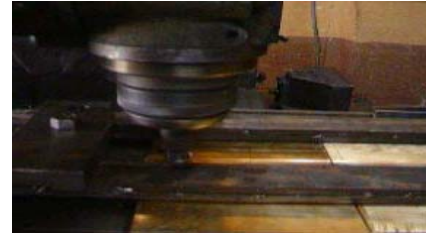
b) Karıştırıcı ucun levhaların birleştirme eksenine üzerine konumlandırılması
