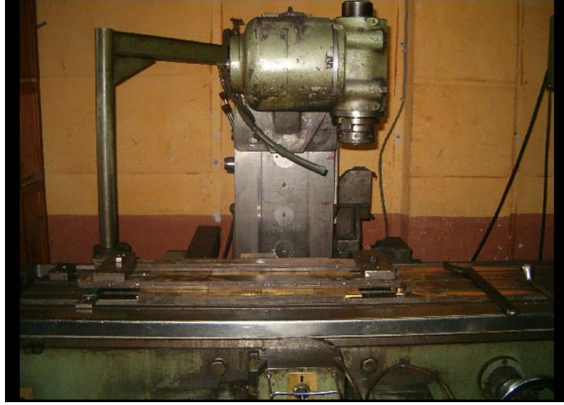
Şekil 5.4. Sürtünme karıştırma kaynak işleminde kullanılan universal dikey freze
