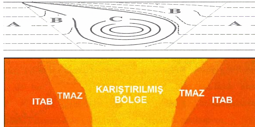
Şekil 2.9. Sürtünme karıştırma kaynağında oluşan iç yapının şematik olarak görünümü. A: ısı tesiri altında kalan bölge (ITAB), B: Termodinamik olarak yeniden kristalleşen bölge (TMAZ), C: Karışım bölgesi (SZ) [30]
