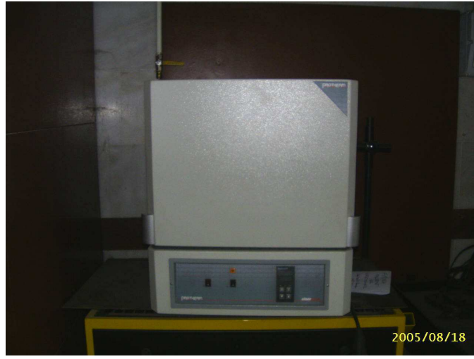
Şekil 5.2. PROTHERM tipi tavlama fırını
