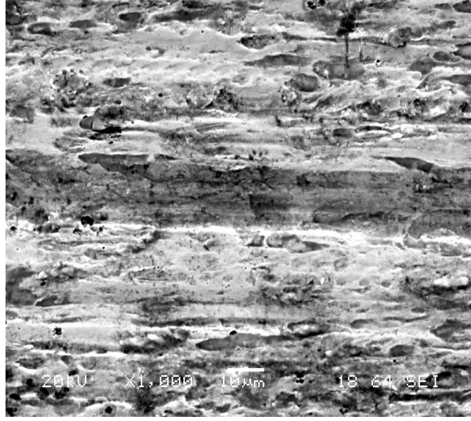
Şekil 6.23. Kaynaksız plakanın 5 N yük altındaki aşınma görüntüsü
