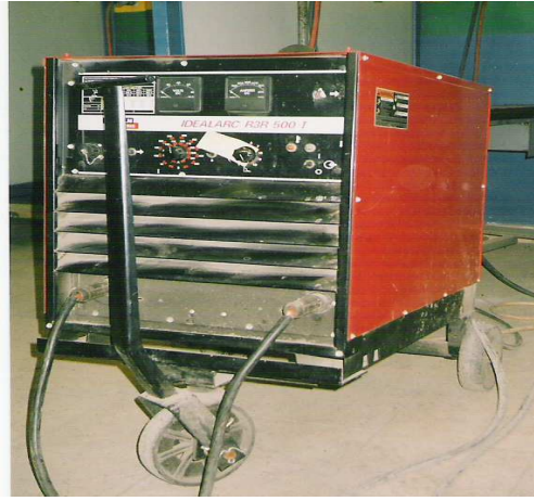
Şekil 5.4. Dolgu kaynağı işleminde kullanılan redresör tipi kaynak makinesi.
