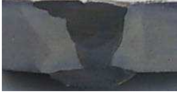
Şekil 6.9. E2-UM-60 Z ile kaynak yapılan numune
