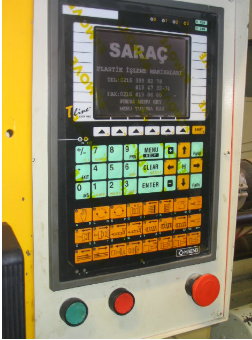
Şekil 8.2. Deneyde kullanılan plastik enjeksiyon tezgahının elektronik kontrol ünitesi
