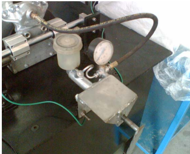
Şekil 6.12. Fren merkez pompası - manometre ve basınç ünitesi
