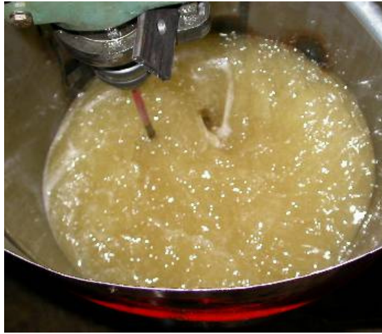
Şekil 3.1 Biyodizel üretim anından bir görünüm (Esterleştirme reaksiyonu.)
