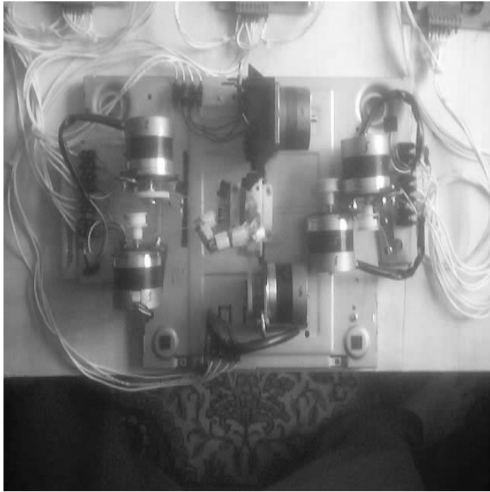
Şekil 3.15. Parmak ve motorların sac levhaya montajlanmış hali
