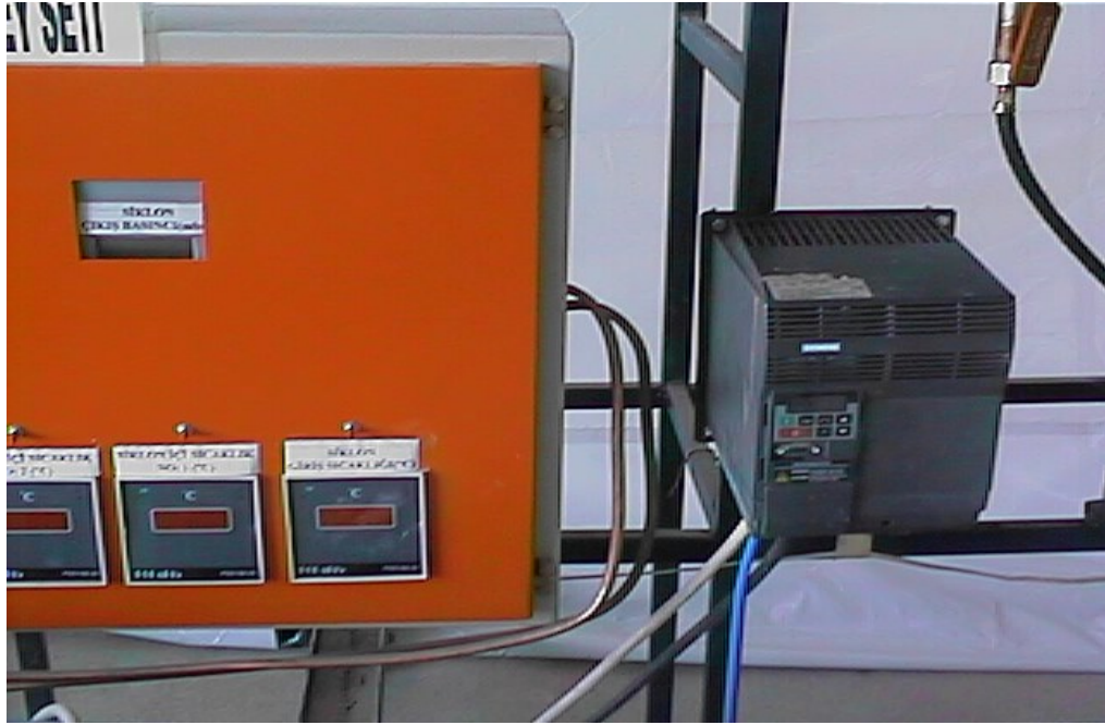
Şekil 3.1.14. Vantilatöre yol veren frekans invertörü
