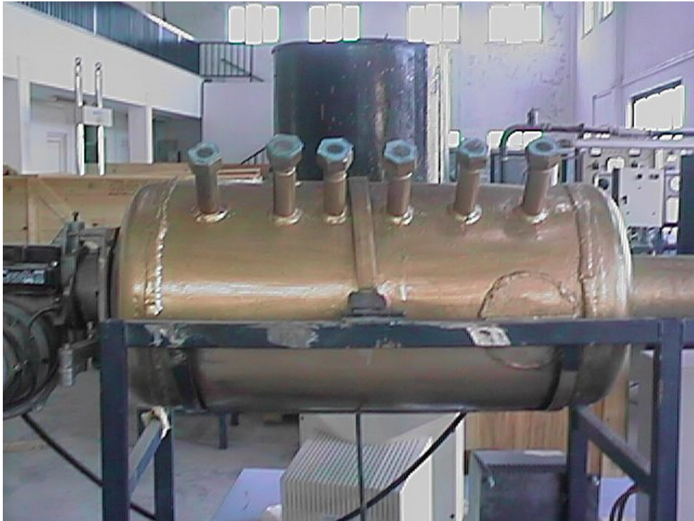
Şekil 3.1.9. Yanma odası gözetleme delikleri ve sekonder hava ihtiyaç menfezleri
