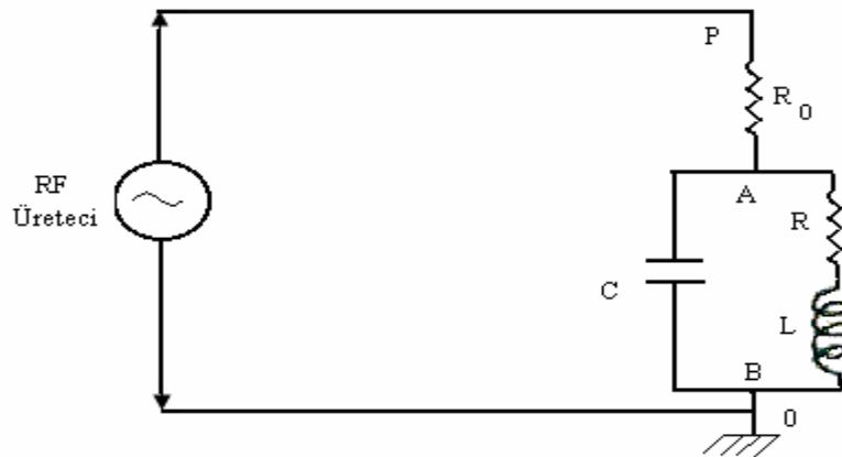
Şekil 2.4 Şekil 2.3'ün özdeşi olan paralel LRC rezonans temel devresi
