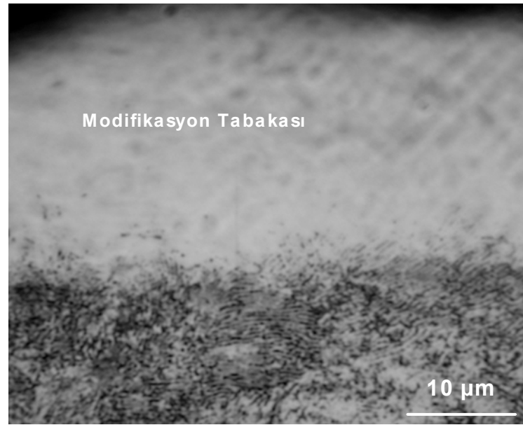
Şekil 8.15 b 1G numuneye ait optik mikroyapısı (x100)
