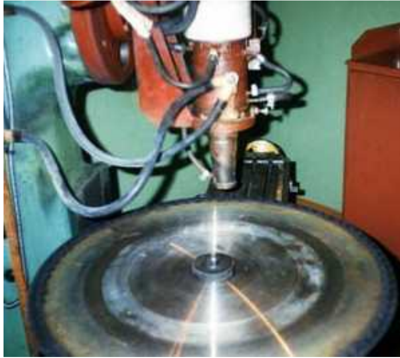
Şekil 5.2 İş parçasına pulse plazma tekniği uygulanması [24]
