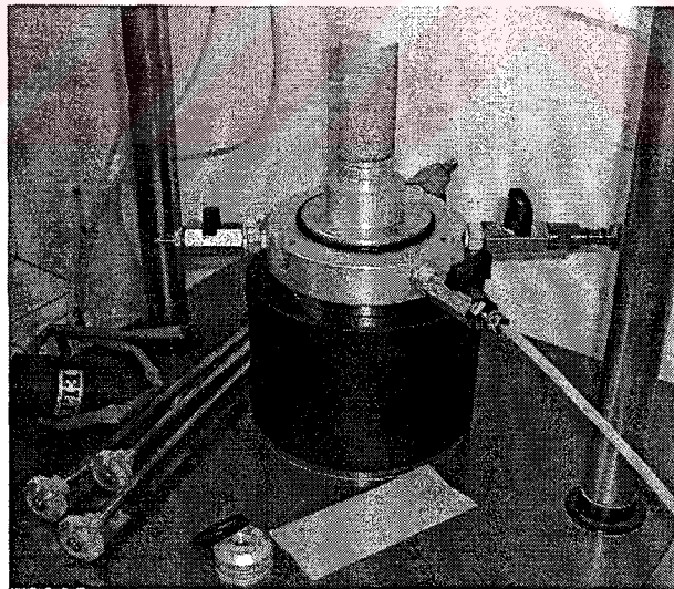
Şekil 5.3 Üç eksenli deneyde numune yerleştirme
