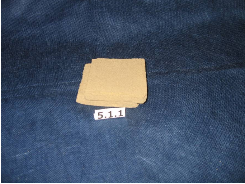
Şekil Ek.B.1. %10 Orta kum + %90 Kilin 100kPa yük altında kesilen numune fotoğrafı
