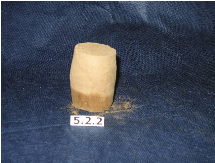
Şekil Ek.C.2. %10 Orta kum + %90 Kilin 200kPa yük altında kırılan numune fotoğrafı
