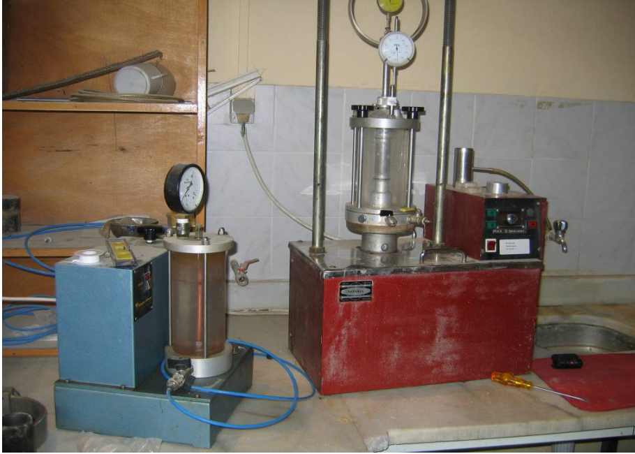
Şekil 4.4. Üç eksenli basınç deney aleti
