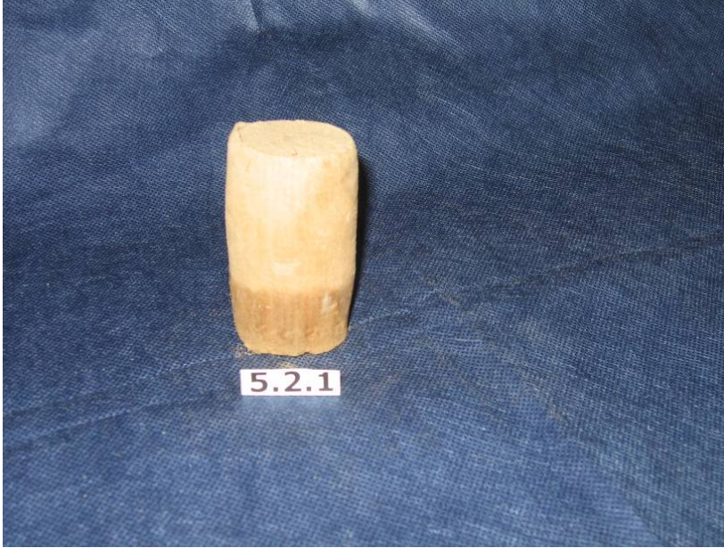
Şekil Ek.C.1. %10 Orta kum + %90 Kilin 100kPa yük altında kırılan numune fotoğrafı
