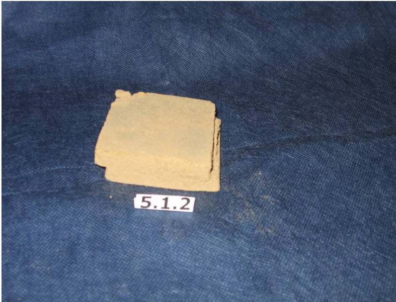
Şekil Ek.B.2. %10 Orta kum + %90 Kilin 200kPa yük altında kesilen numune fotoğrafı
