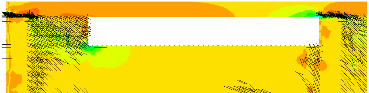
Şekil 5.13. B4 tipi yapı modelinde zemin kat gerilme ve çatlama şekli.
