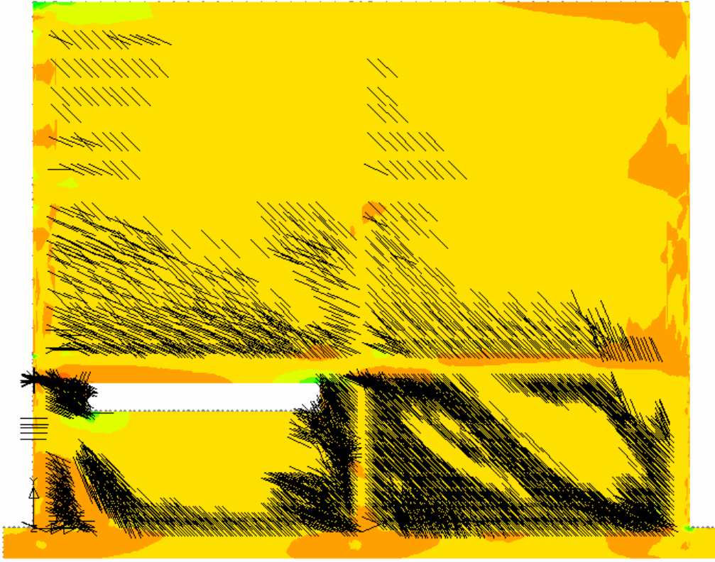
Şekil 5.27. D5 Tipi yapı modelinin çatlama ve gerilme dağılımı
