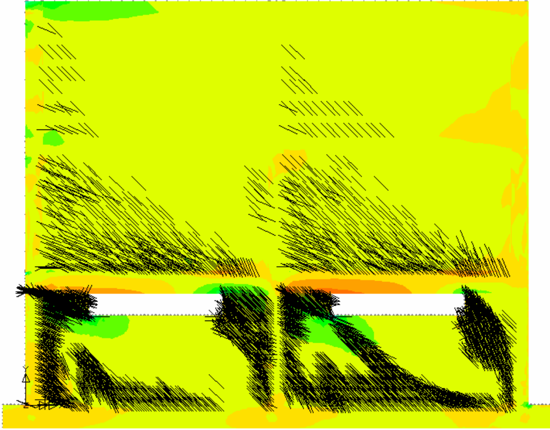
Şekil 5.32. E5 Tipi yapı modelinin çatlama ve gerilme dağılımı
