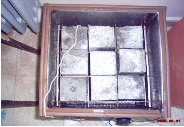
Şekil 6.5. Beton Prizma Kür Tankı
