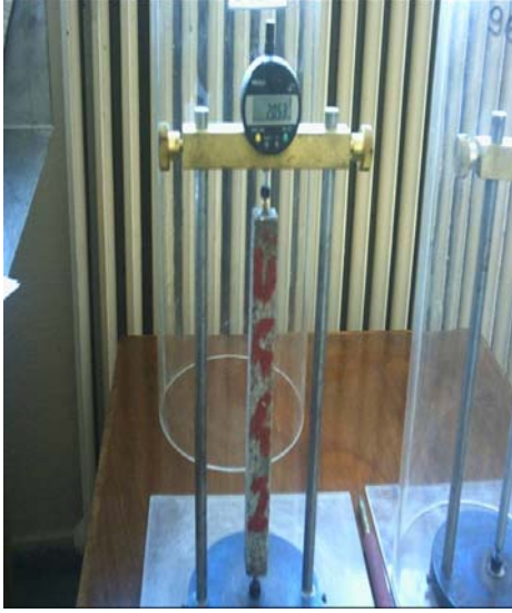
Şekil 5.3. Dijital komparatör ile örneklerin boy ölçümü
