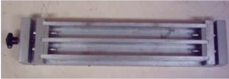
Şekil 6.1. Harç çubuğu üretiminde kullanılan 25x25x285 mm boyutlarında kalıplar
