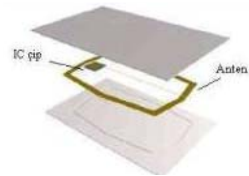
Şekil 3.5. Temassız akıllı kart yapısı[16]
