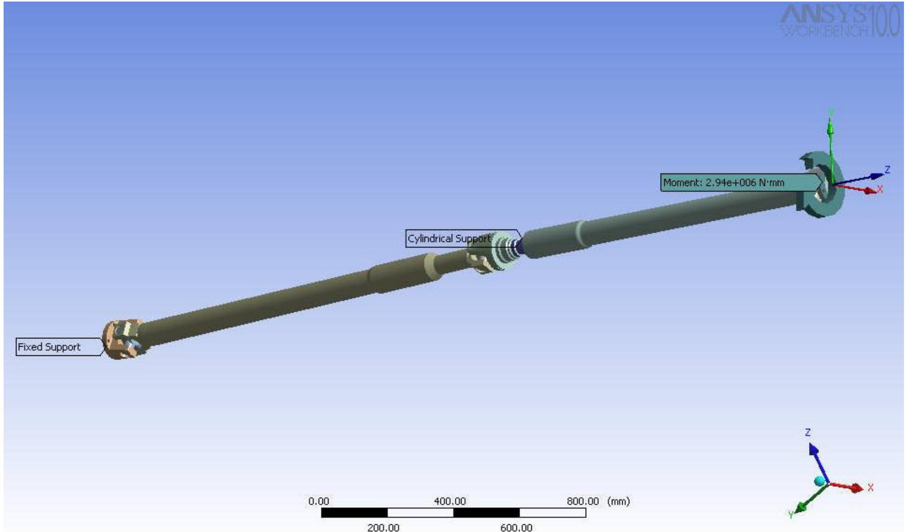
Şekil 6.4 Kardan Millerinde Sınır Şartları
