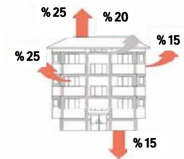
Şekil 1.2. Binalarda Isı Kayıpları
