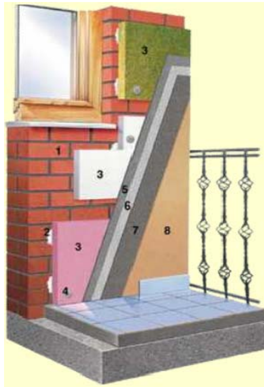
Şekil 4.7. Levha Halindeki Isı Yalıtım Malzemelerin Duvara Uygulanışı
