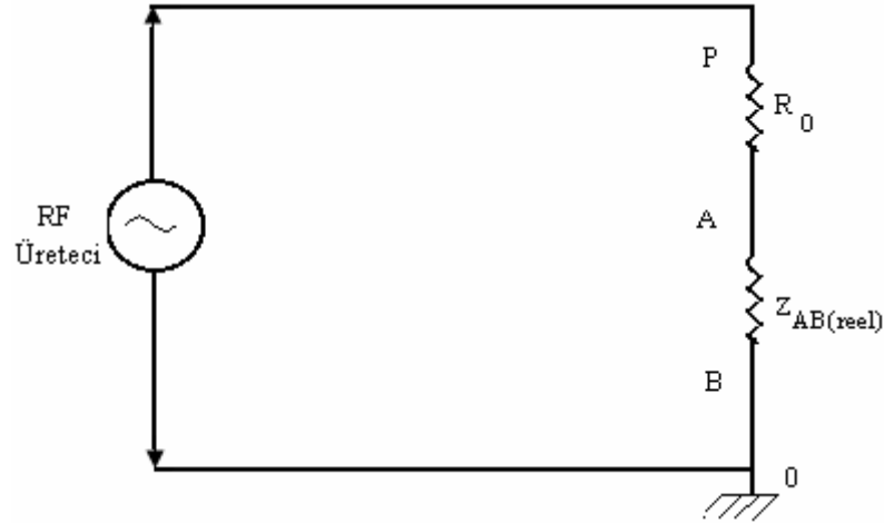
Şekil 2.5 Paralel LRC devresinin rezonans durumunda empedansı reeldir, ( Z_{AB}(\text{reel}) )
