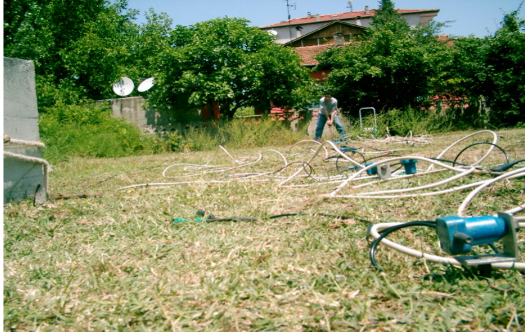
řekil 3.4. Jeofonların kayıt için yerleřtirilmesi
