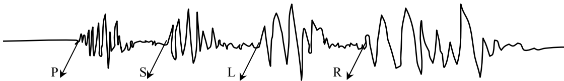
Şekil 2.8. Bir sismografda görülen tipik deprem dalgaları [37]
