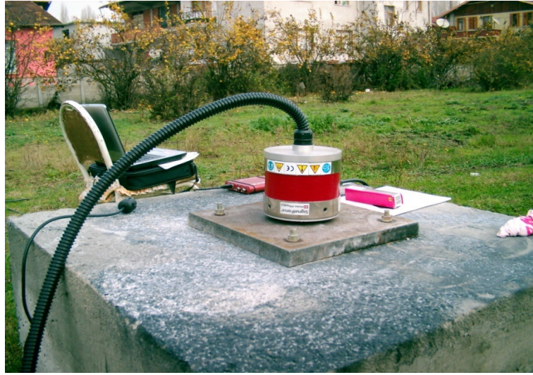
Şekil 3.9. Sarsma cihazı (Inertial shaker)
