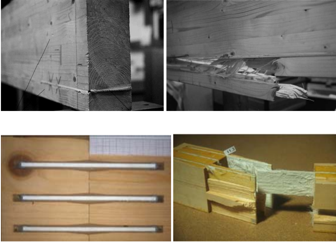
Şekil 3.12. Eğilme deneyine tabi tutulan FRP'lerle güçlendirilmiş deney numuneleri
