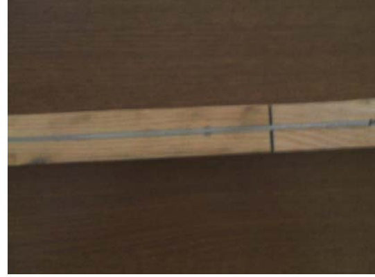
Şekil 5.45. Çekme deneyine tabi tutulmuş tek CTP çubuk tek kavelalı ahşap numune
