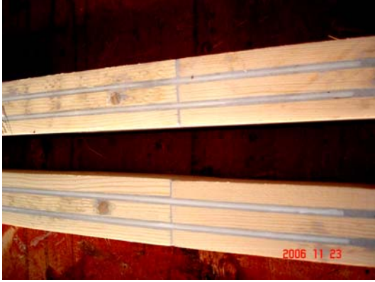
Şekil 5.58. Çift CTP çubuk tek kavelalı Ahşap numune
