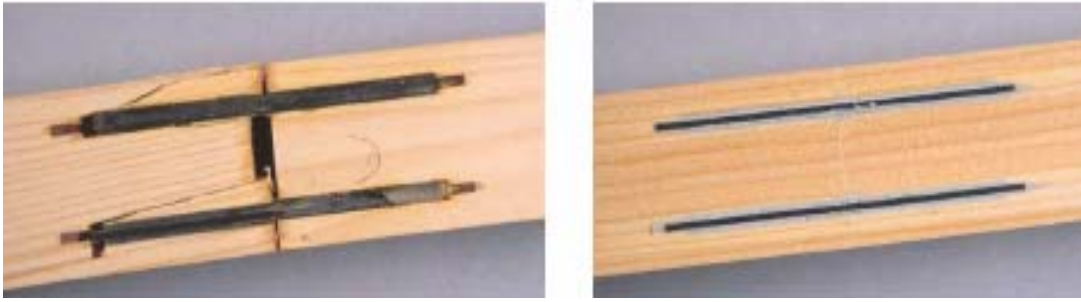
Şekil 3.13. Çekme deneyine tabi tutulan FRP'lerle güçlendirilmiş deney numuneleri
