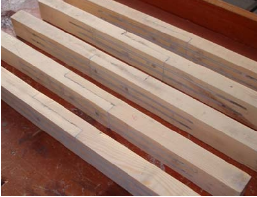
Şekil 5.65. Çift CTP Çubuk Çift Kavelalı Ahşap Numune
