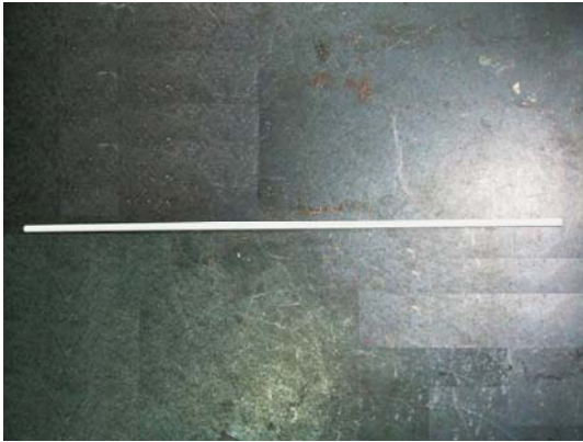
Şekil 5.1. CTP çekme numunesi
