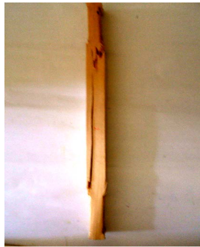
Şekil 5.7. Çekme deneyine tabi tutulmuş masif ahşap
