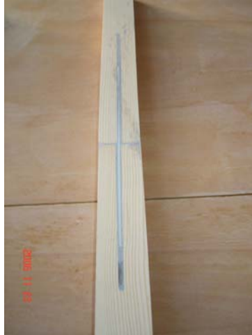
Şekil 5.31 Tek CTP çubuklu ahşap numune
