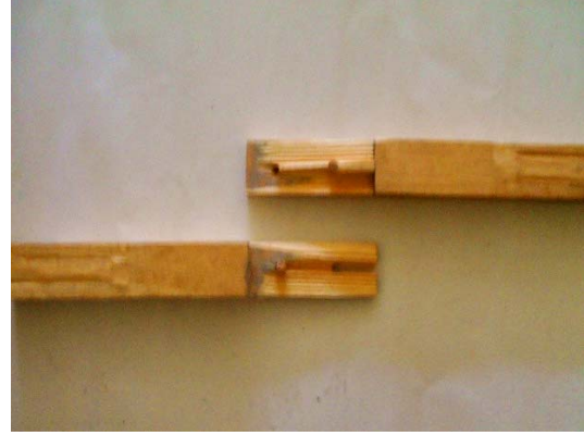
Şekil 5.25. Çekme deneyine tabi tutulmuş Çift kavelalı ahşap numune
