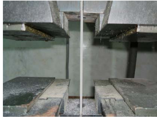
Şekil 5.2. Çekme deneyine tabi tutulmuş CTP çekme numuneleri
