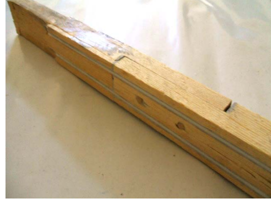
Şekil 5.66. Çekme Deneyine Tabi Tutulmuş Çift CTP Çubuk Çift Kavelalı Ahşap Numune
