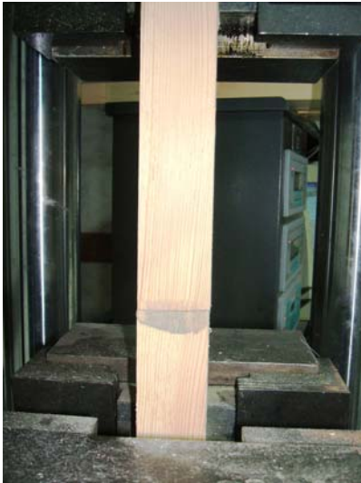
Şekil 5.12. Çekme makinesine bağlanmış yapıştırılarak birleştirilmiş ahşap numune
