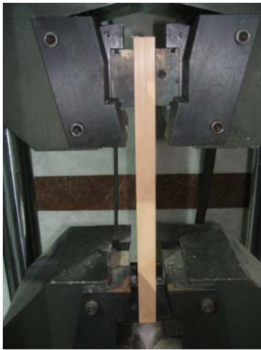
Şekil 5.6. Çekme makinesine yerleştirilmiş masif ahşap
