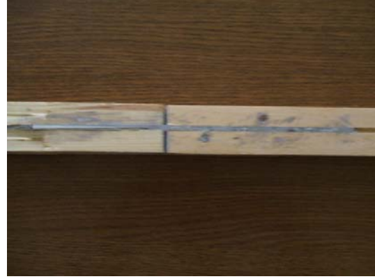
Şekil 5.52. Çekme deneyine tabi tutulmuş tek CTP çubuk çift kavelalı ahşap numune
