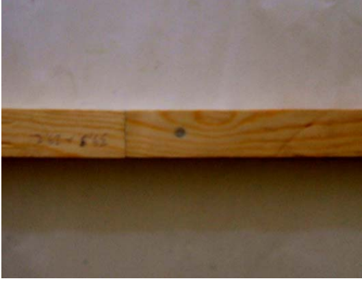
Şekil 5.18. Tek kavelalı ahşap numune
