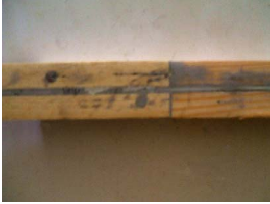
Şekil 5.51. Tek CTP çubuk çift kavelalı Ahşap numune
