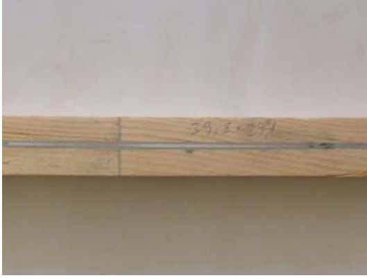
Şekil 5.44. Tek CTP çubuk tek kavelalı Ahşap numune
