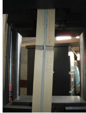
Şekil 5.32 Çekme deneyine tabi tutulmuş tek CTP çubuklu ahşap numune
