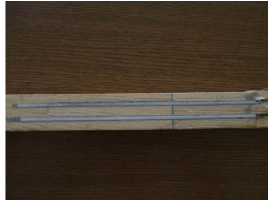
Şekil 5.38. Çekme deneyine tabi tutulmuş Çift CTP çubuklu ahşap numune
