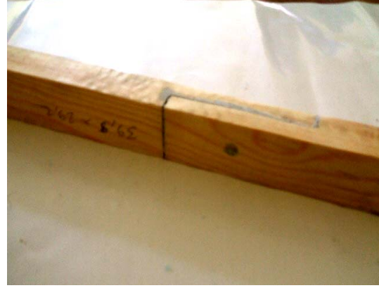
Şekil 5.19. Çekme deneyine tabi tutulmuş Tek kavelalı ahşap numune
