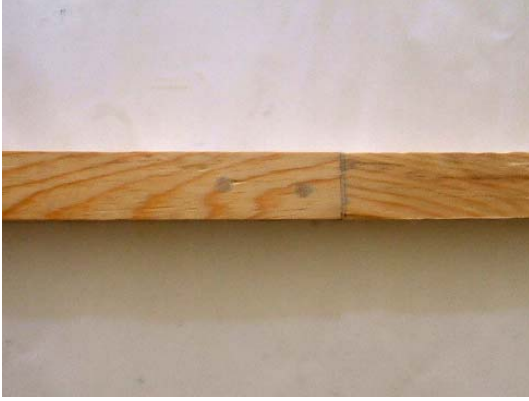
Şekil 5.24. Çift kavelalı ahşap numune
