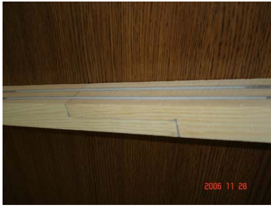
Şekil 5.37. Çift CTP çubuklu ahşap numune
