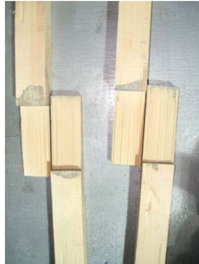
Şekil 5.13. Çekme deneyine tabi tutulmuş yapıştırılarak birleştirilmiş ahşap numune
