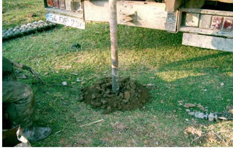
Şekil 4.6 Zemin laboratuar deneyleri için sondaj çalışması
