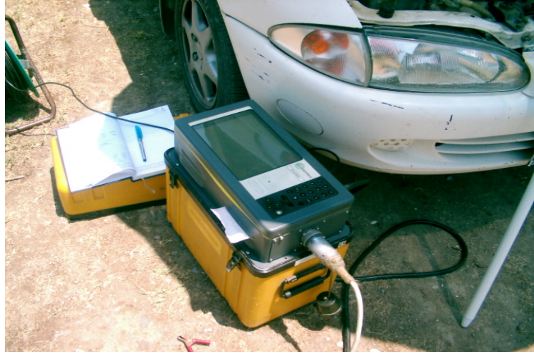
Şekil 4.2 Sismik kırılma deneyi kayıt cihazı
