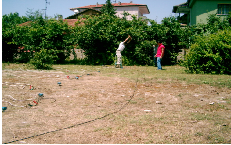
Şekil 4.5 Sismik kırılma deneyi için jeofon uygulaması
