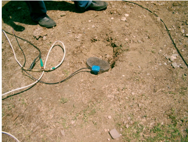
Şekil 4.3 Sismik kırılma deneyi yük uygulama noktası
