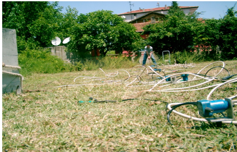
Şekil 4.4 Sismik kırılma deneyi jeofon uygulaması
