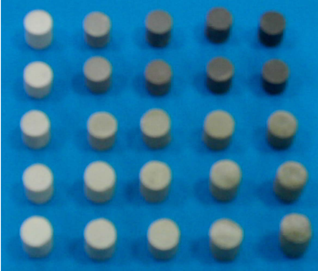
Şekil 6.1. Deney numunelerinin makro görüntüleri a) Soldan sağa bazalt artışı b) Yukarıdan aşağıya sinterleme sıcaklığı artışı
