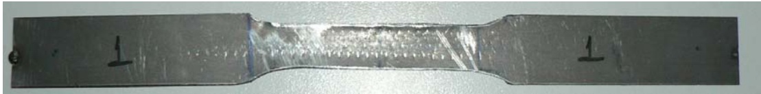
řekil 3.2 ekme deneYine tabi tutulan ana malzeme numunesi
