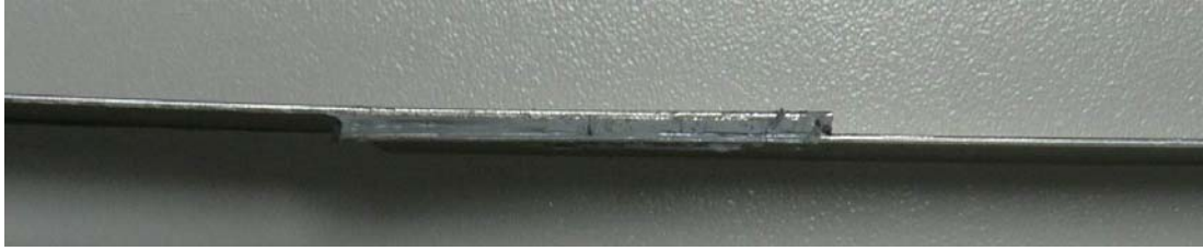
Şekil 3.6 Terostat 9120 ile yapıştırılmış bir numunenin yapıştırma alanı
