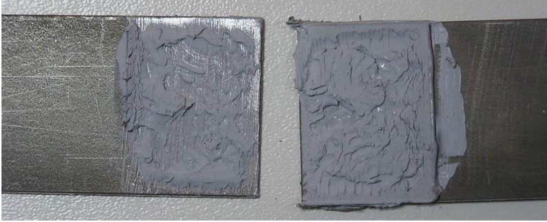
Şekil 3.14 Terostat 9120 ile yapıştırılmış malzemenin çekme deneyi sonrası görüntüsü
