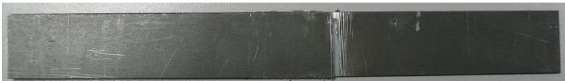
Şekil 3.5 Terostat 9120 ile yapıştırılmış bir numune
