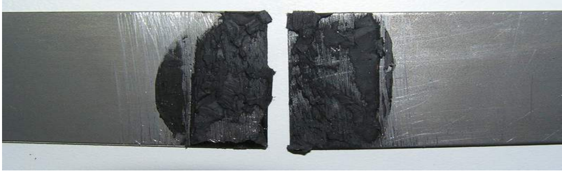
Şekil 3.19 Terostat 9220 ile yapıştırılmış malzemenin çekme deneyi sonrası görüntüsü
