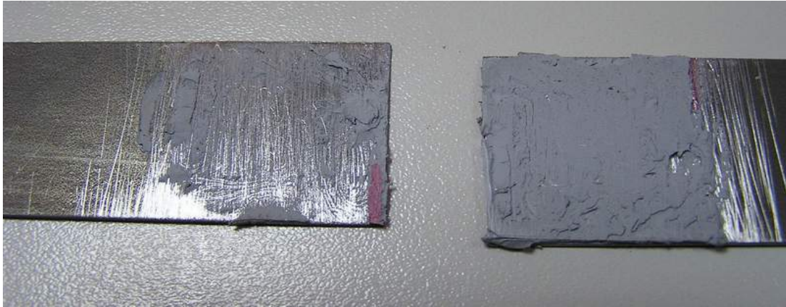
Şekil 3.13 Terostat 9120 ile yapıştırılmış malzemenin çekme deneyi sonrası görüntüsü
