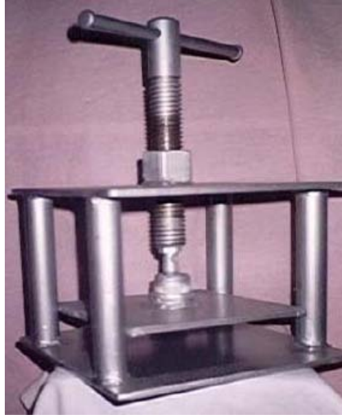
Şekil 3.4 Yapıştırılan malzemelerin preslendiği mekanizma
