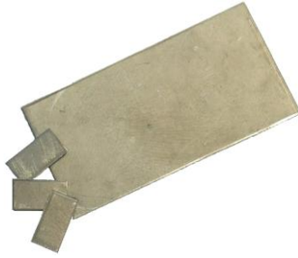
Şekil 3.7. Saf Ferro-niobyumdan elde edilmiş levha
