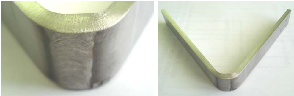
Şekil 5.12. Eğme deneyi sonrası numune fotoğrafları
