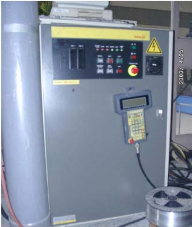
Şekil 3.7. Fanuc robot R-G2 kontrolcüsü [35]
