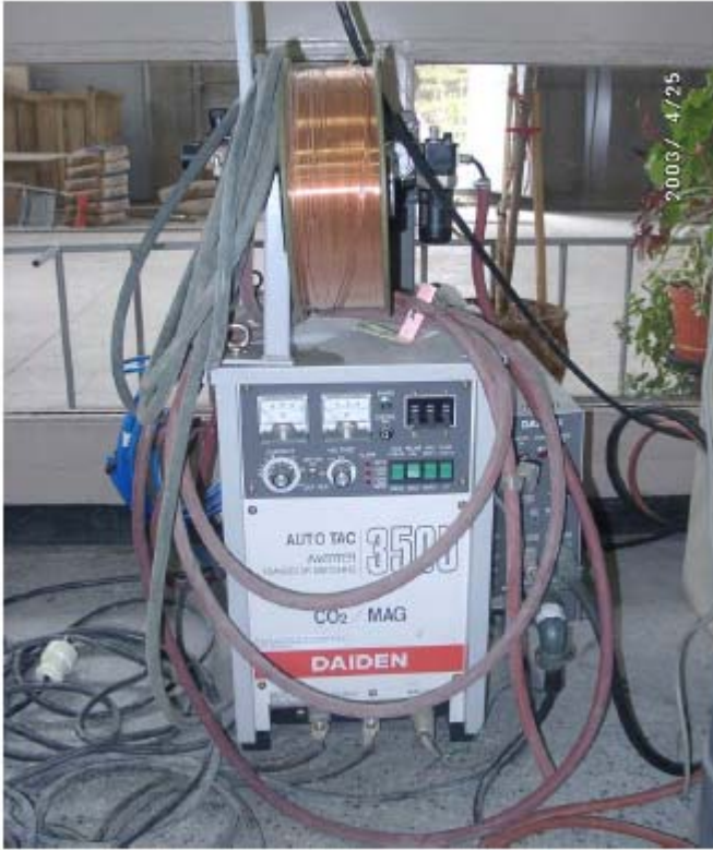
Şekil 3.6. Daiden marka AutoTac 350 U Kaynak makinesi [35]
