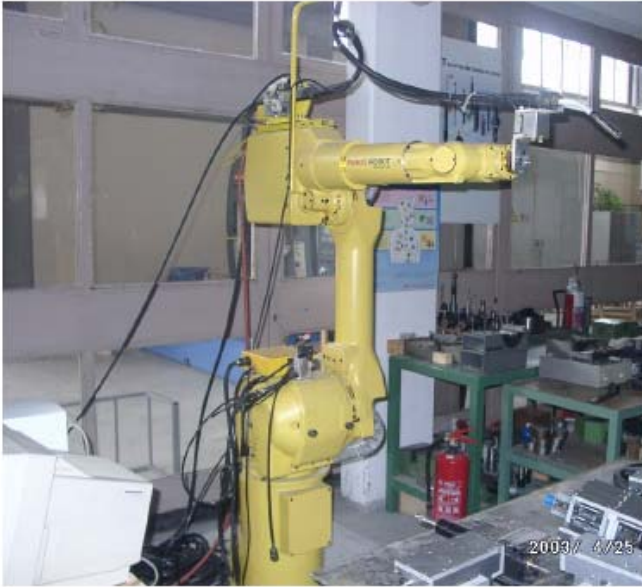
Şekil 3.5. Çok eksenli Fanuc marka kaynak robotu [35]
