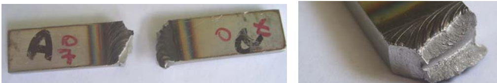
Şekil 5.27. Numunelerin darbe deneyi sonucu kırılmış bazı fotoğrafları
