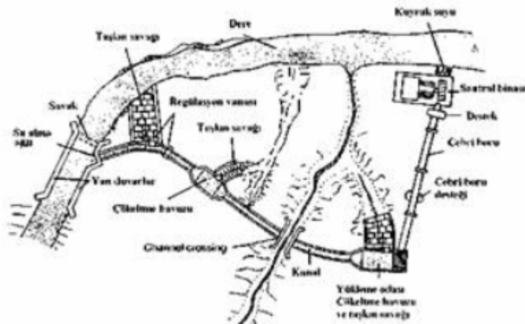
Şekil 6.2. Depolamasız hidroelektrik santralin kısımları
