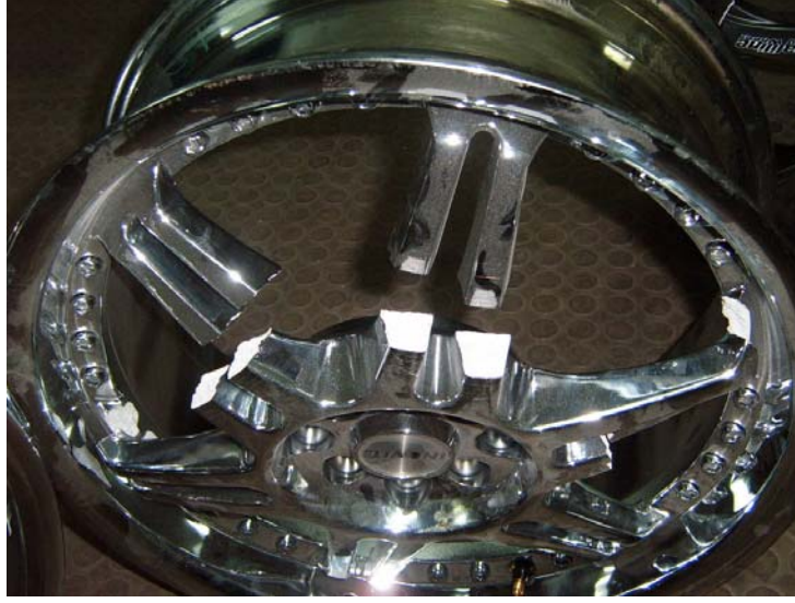
řekil 8.42. ISO Darbe Testi Sonrasında Jantların Grnm I
