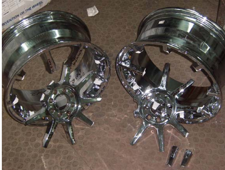
řekil 8.43. ISO Darbe Testi Sonrasında Jantların Grnm II
