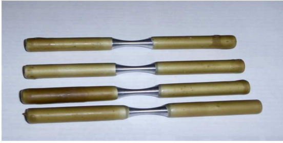
Şekil 5.3. Balmumu ile kaplanmış yorulma deney numuneleri
