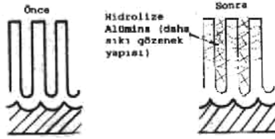
Şekil 2.4. Eloksal tabakasının tespit işlemi öncesi ve sonrası[25]
