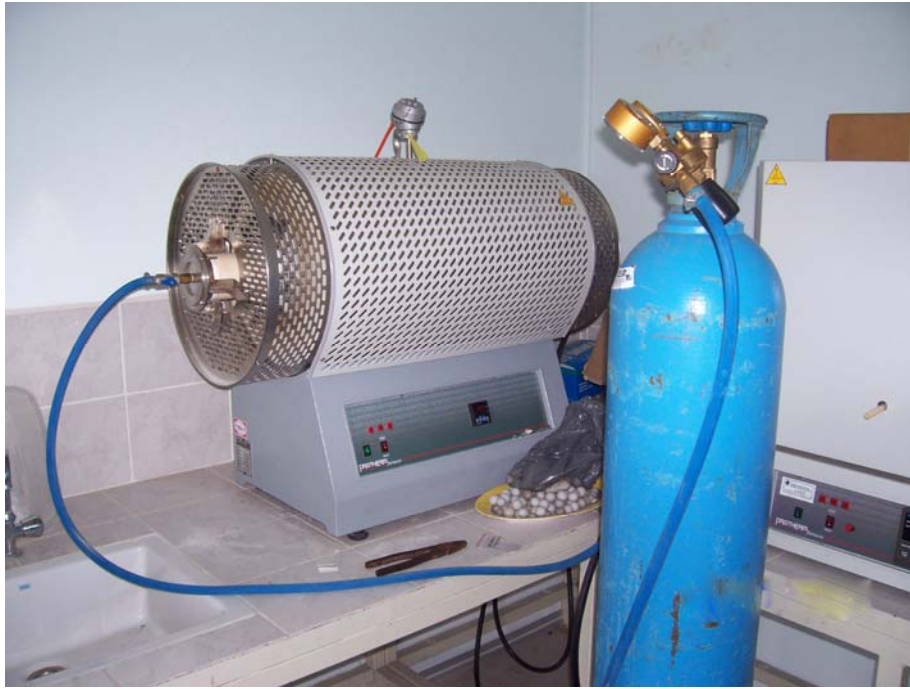
Şekil 5.2. Karbotermal redüksiyon işlemlerinde kullanılan yatay tüp fırın
