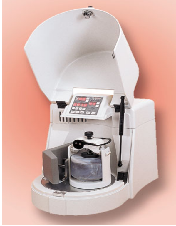
Şekil 5.1. Deneysel çalışmalarda kullanılan gezegensel değirmen
