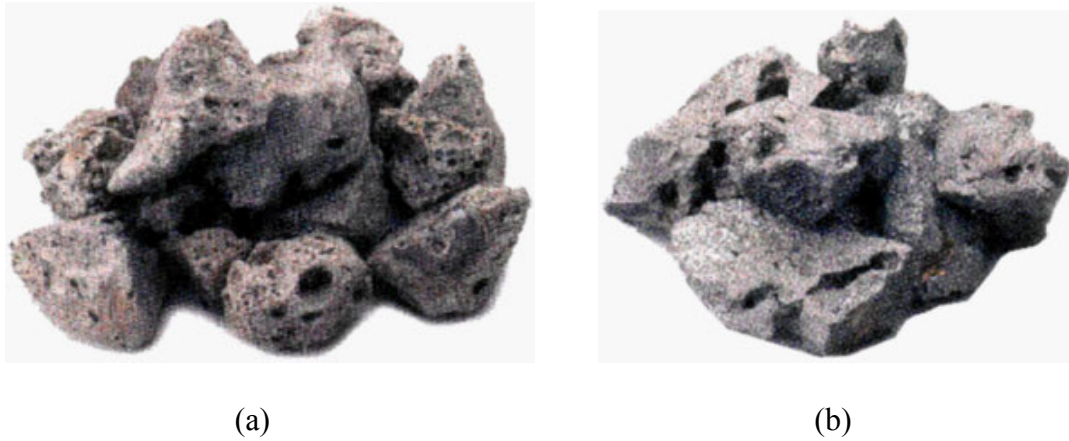
Şekil 3.2. (a) Yüksek karbonlu ferrokrom, (b) düşük karbonlu ferrokrom [28]
