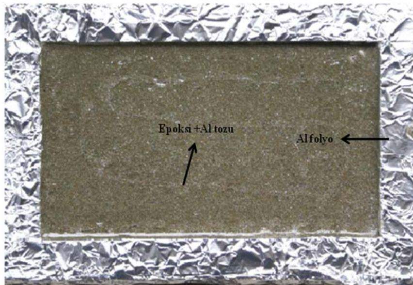
Şekil 6.6. Kaplamanın çerçeveleme ve Al epoksi ile desteklenmesi
