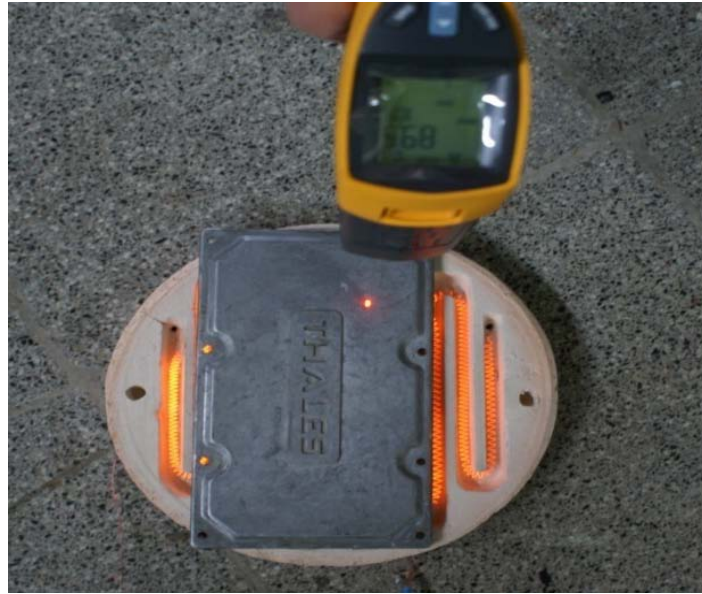
Şekil 6.3. Parçayı ısıtmak için dizayn edilen elektrikli düzenek
