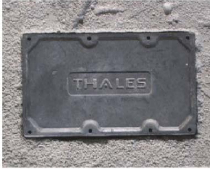
Şekil 6.2. Parçayı sabitlemek için hazırlanmış ytonglu düzenek
