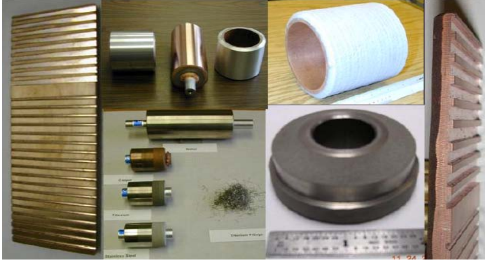
Şekil 2.3. Soğuk spreyn prosesleri ile kaplanan bazı ticari araç ve gereçler [15].
