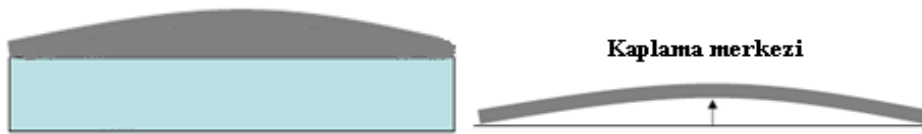
Şekil 7.2. Kaplamalarda merkezden dışa doğru yayınımlar
